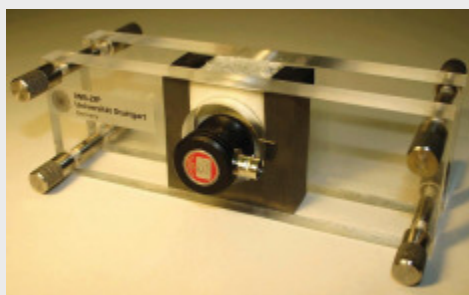
第 15 页 用超声波分析新拌混凝土
