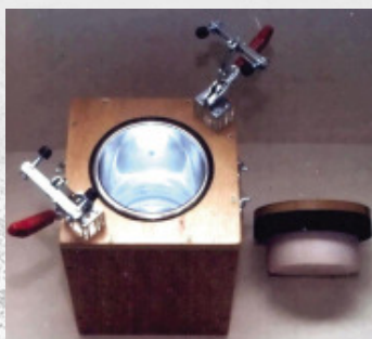
第 15 页 用超声波分析新拌混凝土
