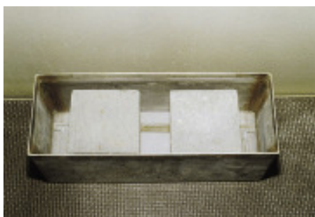
图2 立方体试验(在无溶液容器中的样品)
