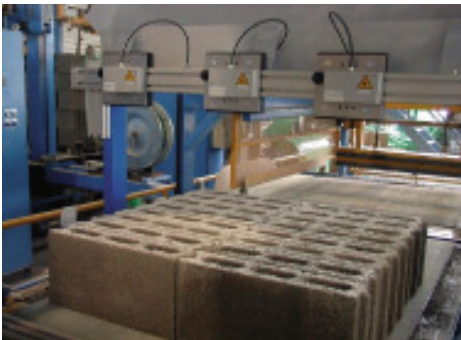
图2 各激光束的工作详图 (用于激光定位的激光滑动器)
