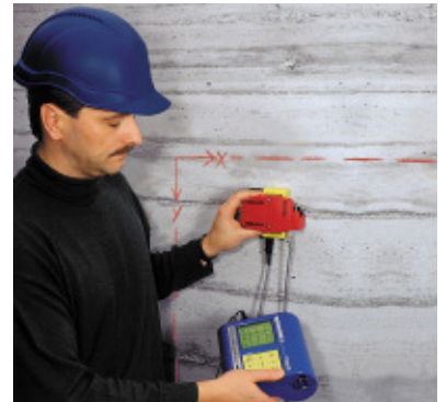
图4 5型Profometer: 扫描钢筋位置
