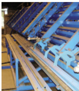
图5 底部带有纵向钢筋给料装置的倾卸式落料装置
