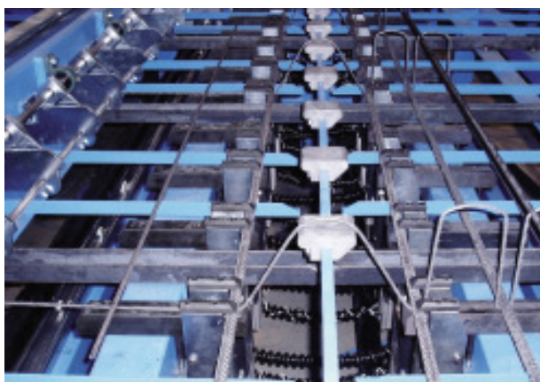
图9 横向钢筋在弯曲台上被向上弯起
