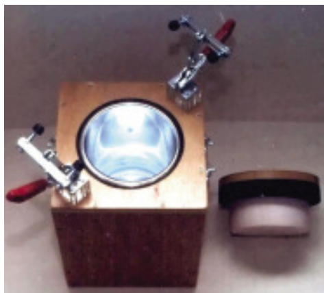
图6 IWB为测量水化热开发的热量计
