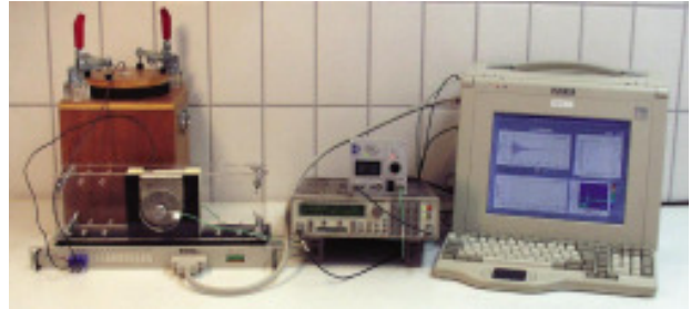
图2 进行新拌混凝土测量的FreshCon-2 系统
