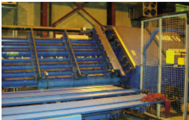
图2 MMR16型转筒式调直切断机
