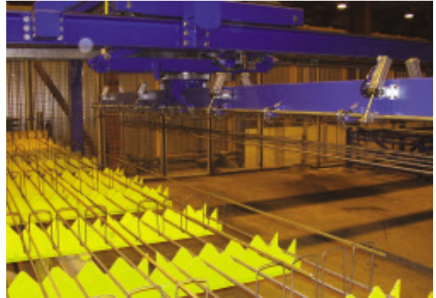
图12 控制设备将钢筋笼子放置在多孔板生产给料装置的适当位置上
