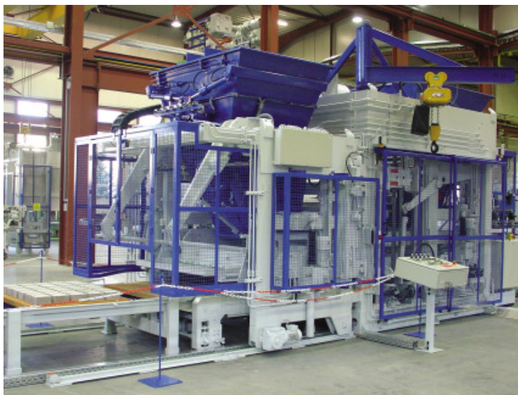
图1 采用860 AZ型成型机的强劲生产系统，构成稳定的生产和第一流的产品品质
