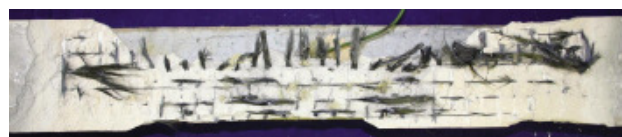
图10 耐火试验后的5-03-2试件(底面观察)
