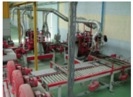
图8 KFC 1000斜面磨削装置
