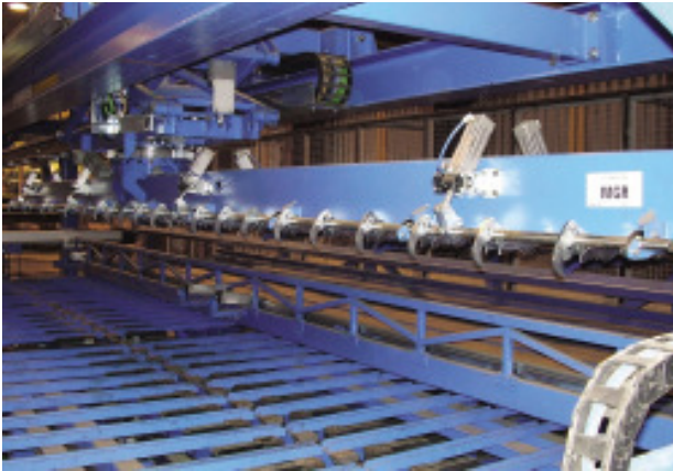
图11 顶部装有控制设备的网片弯曲台
