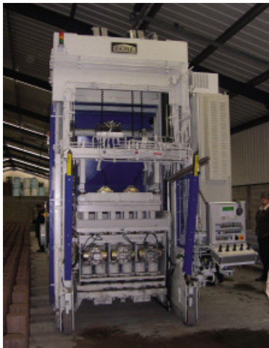
图2 在地面上生产就有可能制造最大高度达1500mm的产品
