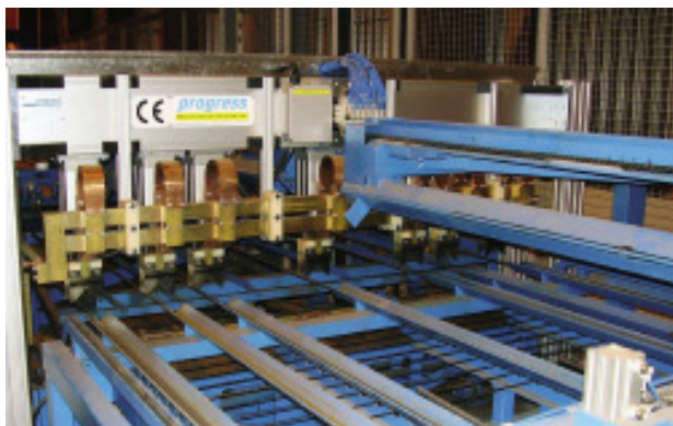
图8 焊接门梁,其上对应的每根纵向钢筋装有一焊接头
