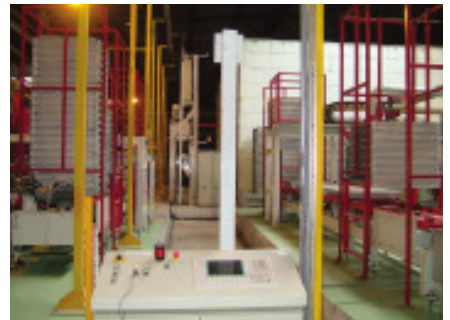
图5 SYNCRO 2000型平板堆放机
