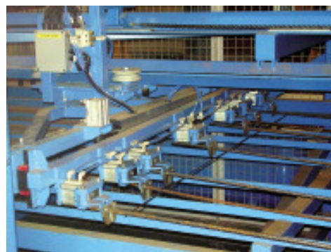
图7 钢网的撤回及移送机组
