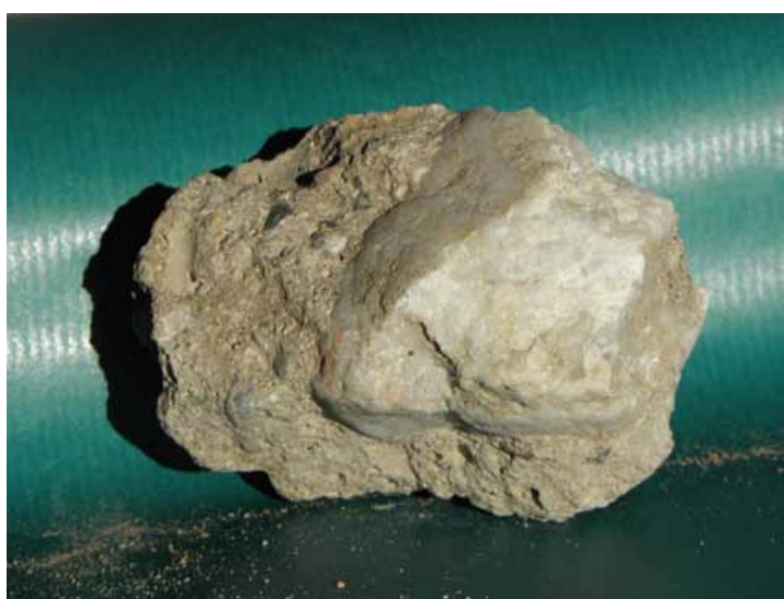
3 Concreto granulado en varias composiciones tomado de una pila de escombros. Arriba: partículas de composite provenientes de agregados unidos por la pasta de cemento. Abajo: partículas de mortero (izquierda) y mortero casi libre de partículas de grava (derecha)
