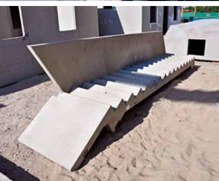
Tejados, balcones y escaleras son fabricados en paralelo en moldes separados
