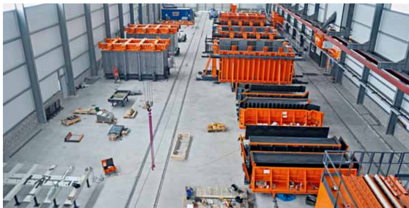
Construcción en Ica con tres moldes, tejados y escaleras modulares, así como moldes de batería
