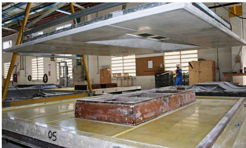
La placa de muro fraguada es levantada del encofrado de concreto: la calidad de la superficie puede competir con la de la piedra natural pulida. También se reconoce perfectamente la sencilla integración de la entalladura.
