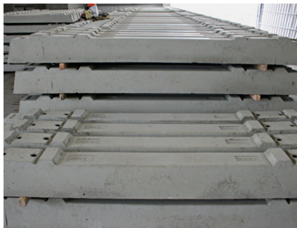
Tras tapar los salientes de armadura, los durmientes de hormigón pretensado aguardan a ser entregados
