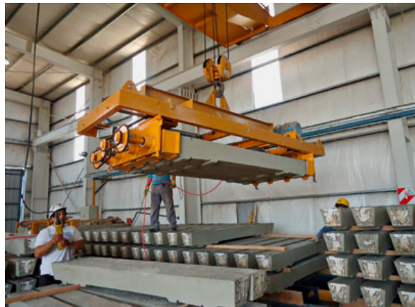
Las pinzas de elevación pueden cargar hasta 8 durmientes y transportarlos al lugar de almacenamiento
