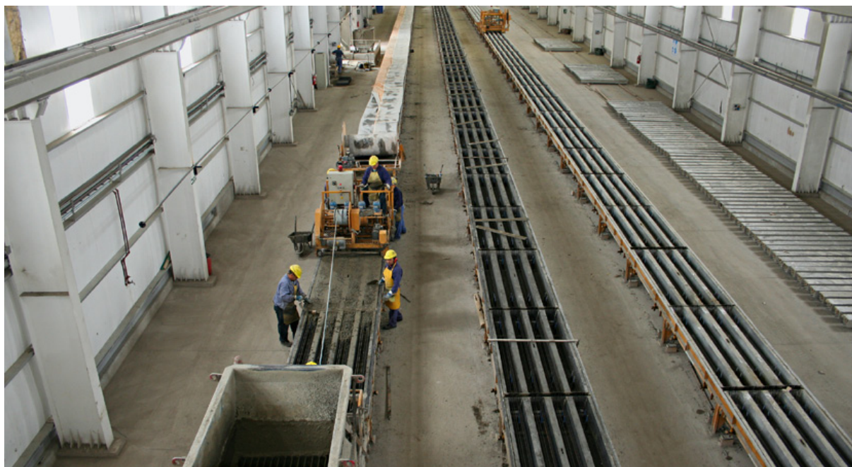
Vista de la nave de producción con las tres líneas de producción de durmientes
