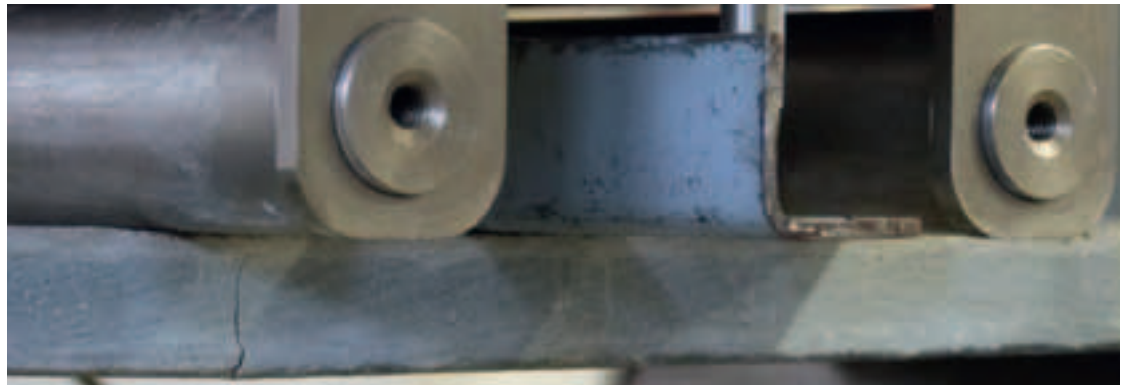
Prüfung filigraner, glasfaserbewehrter UHPC-Elemente
