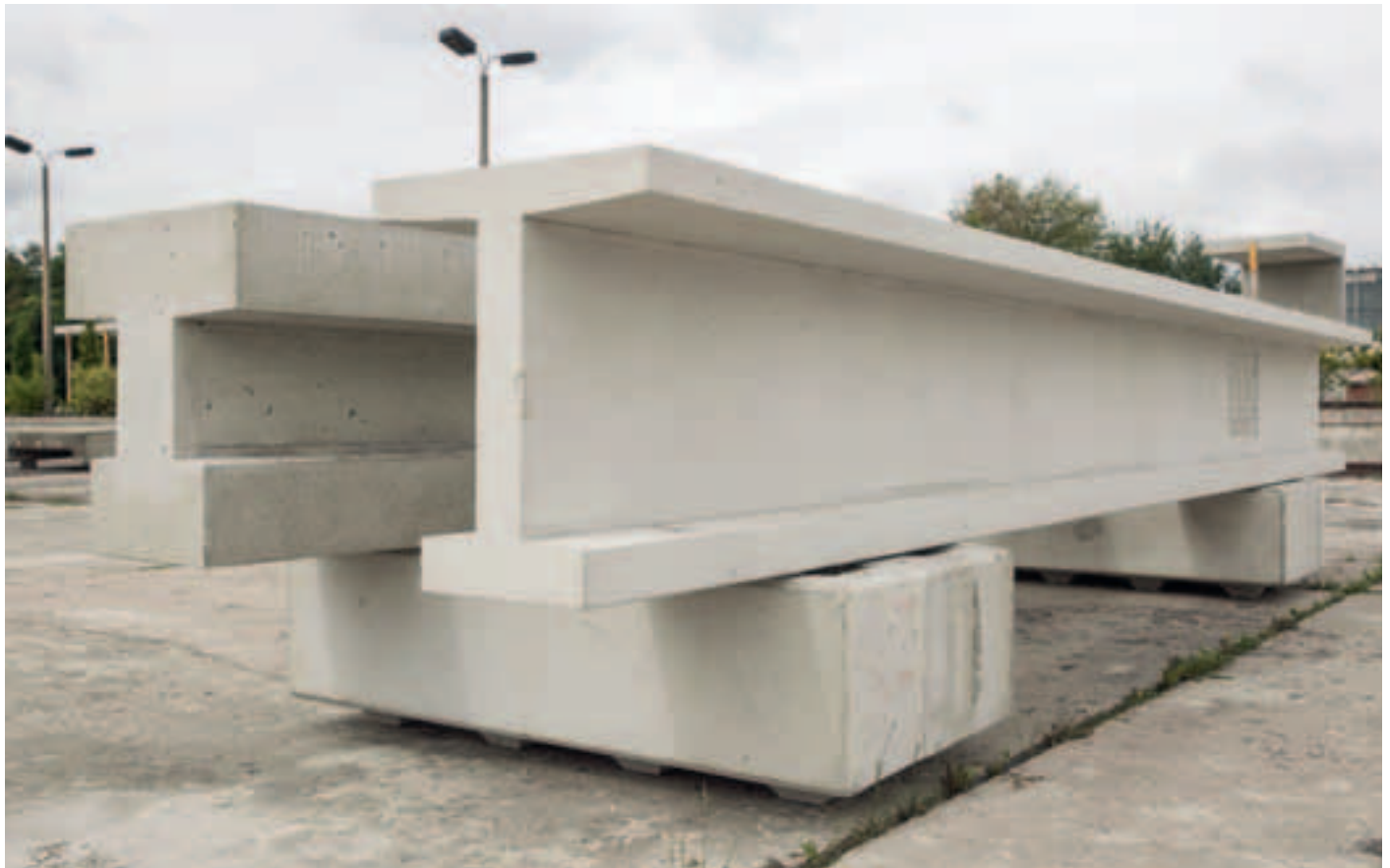
Abb. 3 (Bild oben) Vergleich Stahlbetonträger links, Carbonbetonträger rechts – Herstellung: Beton- werk Oschatz GmbH
