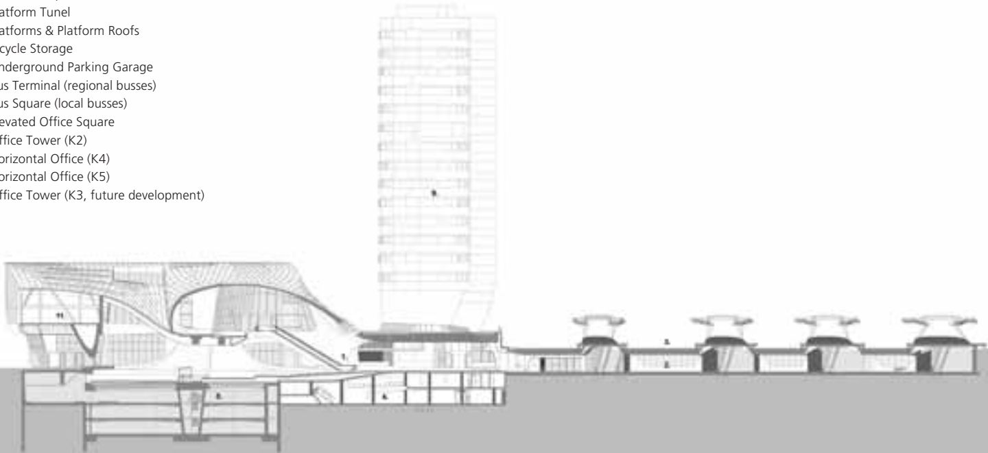
Abb. 3 (Bild oben) Querschnitt durch den Bahnhof und die Halle [M 1 : 1.000]
