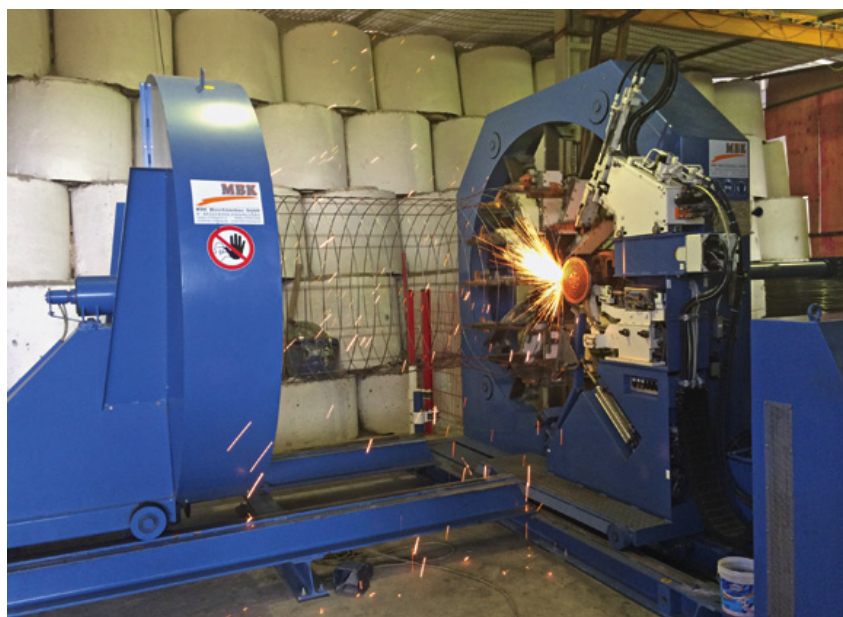
Puesta en marcha en abril de 2013, la máquina de soldadura de armaduras de refuerzo de MBK-190-R en funcionamiento
