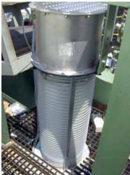
Fig. 8 Filtro ciclón para color en grano Type CF 40, utilizado para colorear placas de techo, en una instalación amasadora de la empresa Jessop en Sudáfrica.
