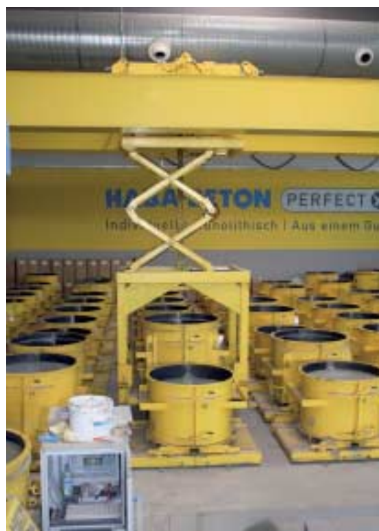
Fig. 9 Grúa portal para el transporte de hormas rellenas con hormigón o preparadas para la producción.
