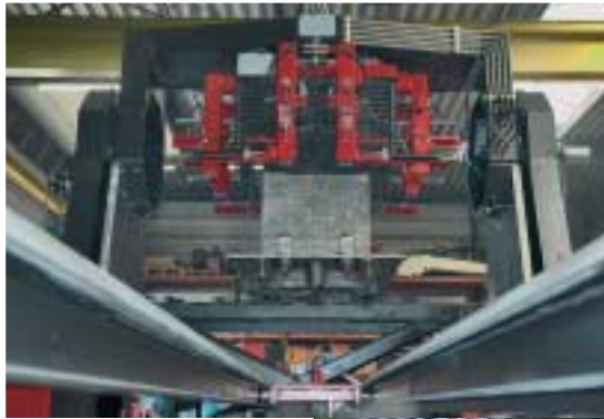
Fig. 3 Una cadena mueve la placa base llevando el paquete de bloques hasta debajo de la jaula. Ahí es depositada en la jaula por una tabla elevadora.
