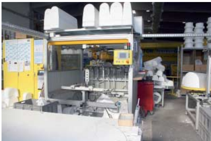
Fig. 5 Alambres calientes cortan los elementos EPS a medida de acuerdo con los requisitos – en este caso, para la producción de conexiones tridimensionales con formas redondas.
