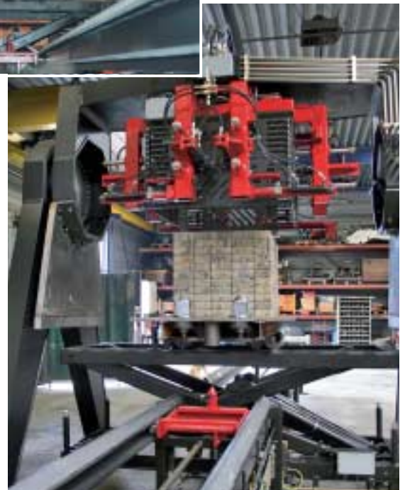
Fig. 3 Una cadena mueve la placa base llevando el paquete de bloques hasta debajo de la jaula. Ahí es depositada en la jaula por una tabla elevadora.
