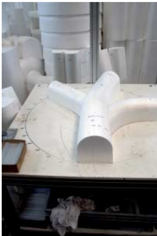
Fig. 6 Uniendo las hormas negativas a los desagües.
