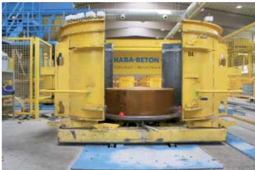
Fig. 7 Molde abierto antes de insertar el elemento de recorte.
