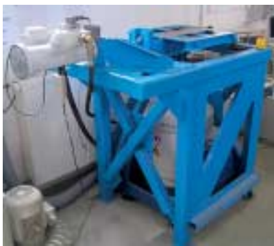
Fig. 11 Vista de la plataforma del laboratorio de prueba para vibración multidimensional (izquierda) y molde de prueba (derecha).
