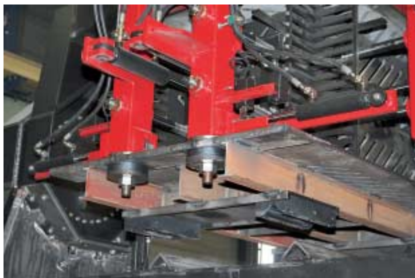
Fig. 5 La placa base es encajada con cuatro ganchos (izquierda) que entran la jaula a través de una estructura. La jaula se cierra con un tornillo hidráulico.
