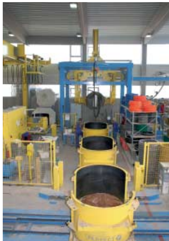
Fig. 12 Estación de girado de pozos. Fig. 12 Estação de curvatura da porta de inspecção.
