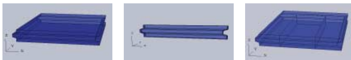
Fig. 5 Vistas de modelos geométricos utilizados para simulaciones de proceso (de izquierda a derecha: elemento de pared, elemento de prisma, elemento de puerta).
