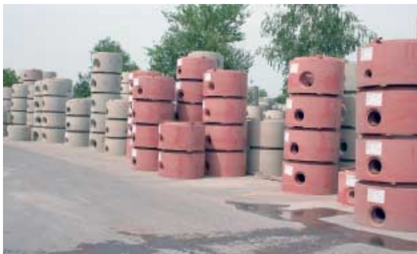
Fig. 1 Área de almacenaje de Teising. En Haba Beton, el color rojo se aplica a las piezas de base de pozos de hormigón de alta prestación (C60/75) para reconocer fácilmente la línea de producto.
