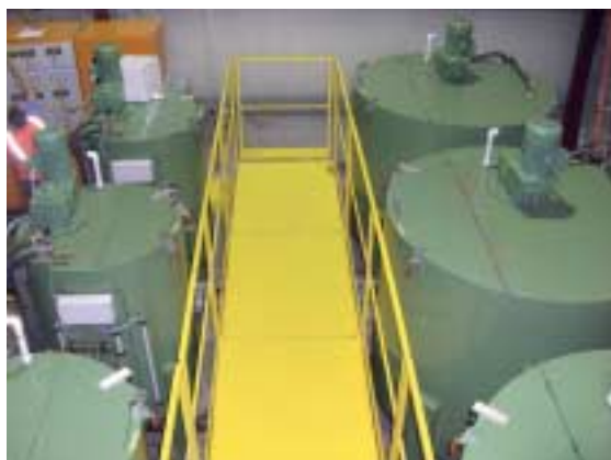
Fig. 3 Vasijas amasadoras MDI 1000 y MDI 2000 para colorear placas de techo, en Florida, EE UU.
