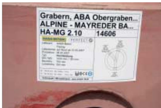
Fig. 3 Etiqueta con información detallada pegada en una pieza de base de pozos desde el principio de la producción hasta el montaje final.
