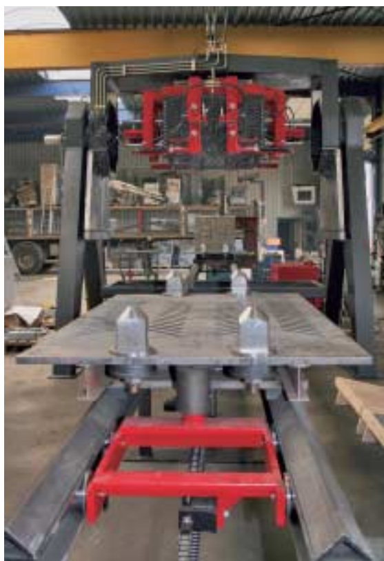
Fig. 5 La placa base es encajada con cuatro ganchos (izquierda) que entran la jaula a través de una estructura. La jaula se cierra con un tornillo hidráulico.
