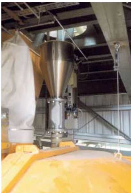
Fig. 1 Balanzas de polvo PW 100 para el vaciado gravimétrico en la amasadora.
