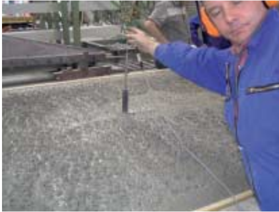
Fig. 22 Medición del efecto de vibración dentro de la mezcla de hormigón durante el impacto de vibración.
