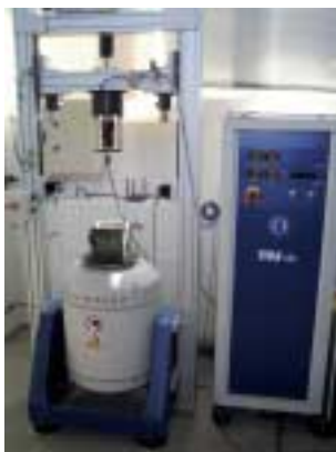
Fig. 10 Vista de la plataforma del laboratorio de prueba para vibración unidimensional (izquierda); molde de prueba con mezcla de hormigón (derecha).
