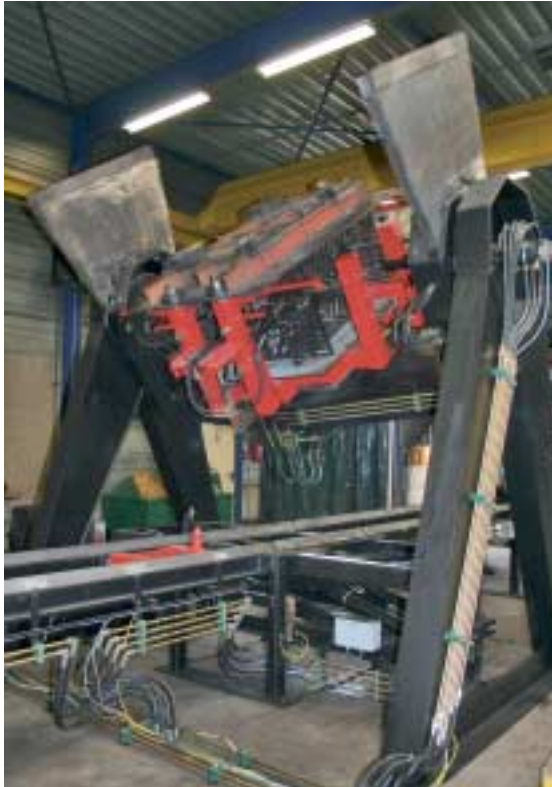
Fig. 4 La jaula entera rota alrededor de los sistemas de ejes x e y.
