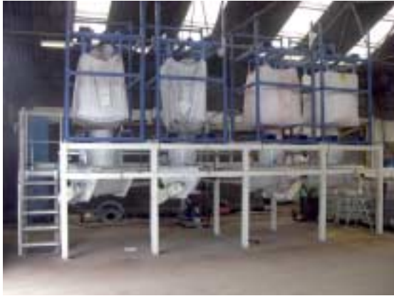
Fig. 5 Sistema dosificador de polvo seco/húmedo Type PB 120 con cuatro dosificadores espirales, para colorear adoquines, en Armstrong, Reino Unido.
