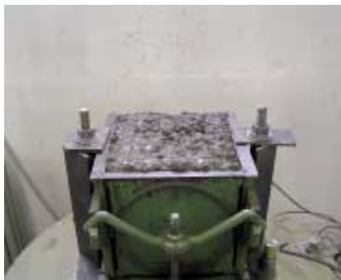
Fig. 10 Vista de la plataforma del laboratorio de prueba para vibración unidimensional (izquierda); molde de prueba con mezcla de hormigón (derecha).
