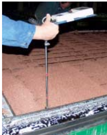
Fig. 4 Medición de cambios dinámicos a presión en hormigón fresco durante el proceso de compactación.
