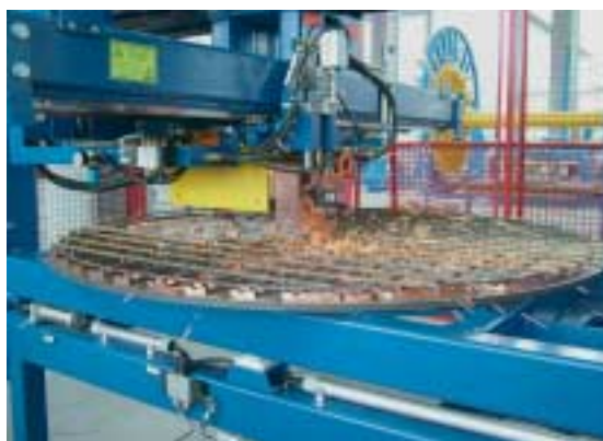
Fig. 3 Proceso de soldadura en una placa giratoria.
