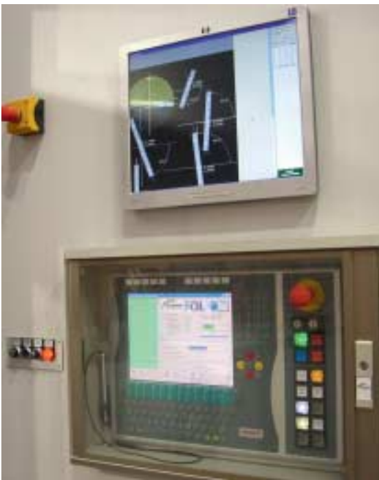
Fig. 8 Análisis de la posición del encofrado después de escanearlo con un sistema de cámara.
