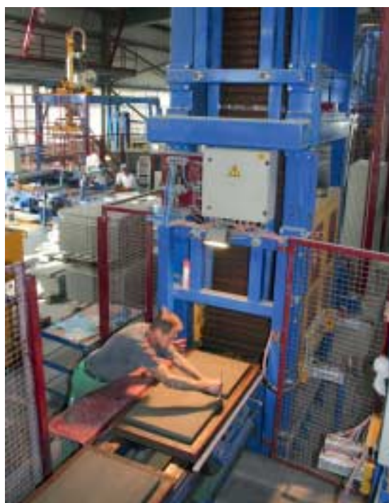
Fig. 8 Antes del almacenamiento de las cámaras de curado, las losas producidas se revisan de modo aleatorio.
