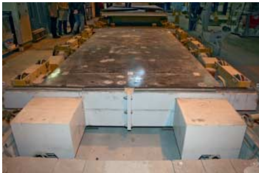
Fig. 6 Las infraestructuras del sistema en las instalaciones de Schlüsselfeld: en primer plano, dos de los cuatro motores.
