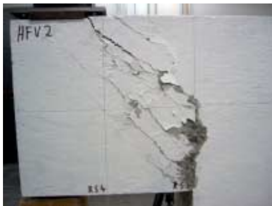
Fig. 11 Patrón de fractura de una ménsula montada con armadura de miembro de tensión con compuesto de alto rendimiento.
