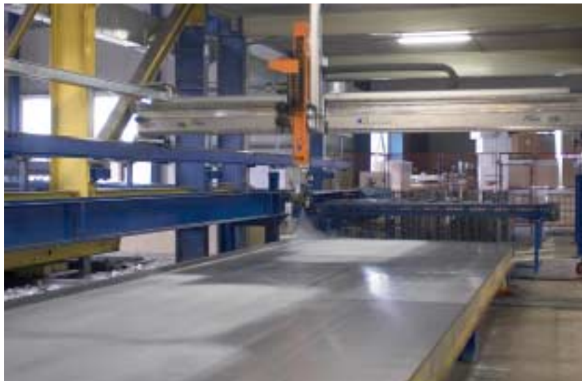
Fig. 3 Engrasado de superficie de encofrado cubierta.
