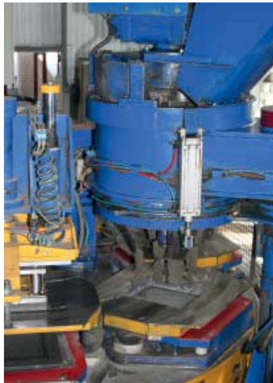
Fig. 6 El aparato de dosificación del revestimiento rellena los moldes.
