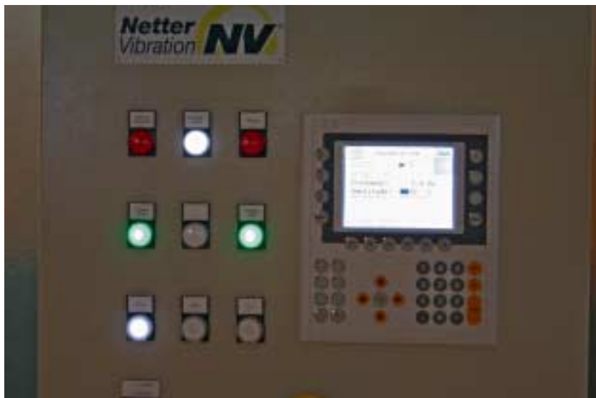
Fig. 8 La unidad de control asegura un ajuste más sencillo de los parámetros para los movimientos longitudinales, transversales y circulares.
