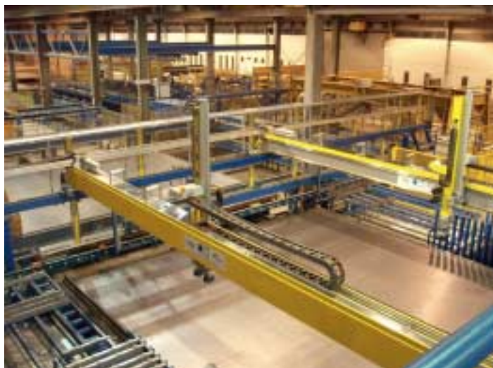
Fig. 10 El sistema de robot doble (MFSR) en Heembeton, Holanda. El PLC de seguridad fue utilizado para desarrollar una compleja estrategia de acceso para asegurar que uno de los robots continúe funcionando si hay un error o fallo.
