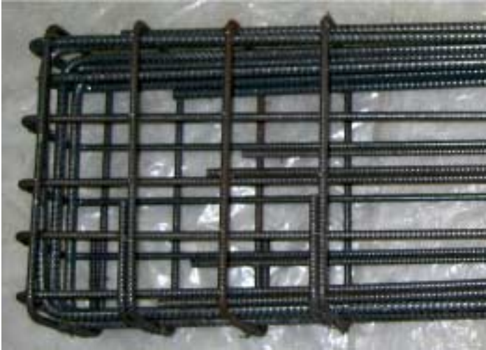
Fig. 10 Armadura de ménsula convencional (izquierda) contra armadura de ménsula con unión de gran resistencia (derecha).
