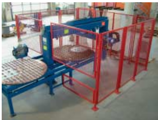
Fig. 1 La nueva máquina semiautomática de MBK permite soldar rejillas para fondos de pozos.
