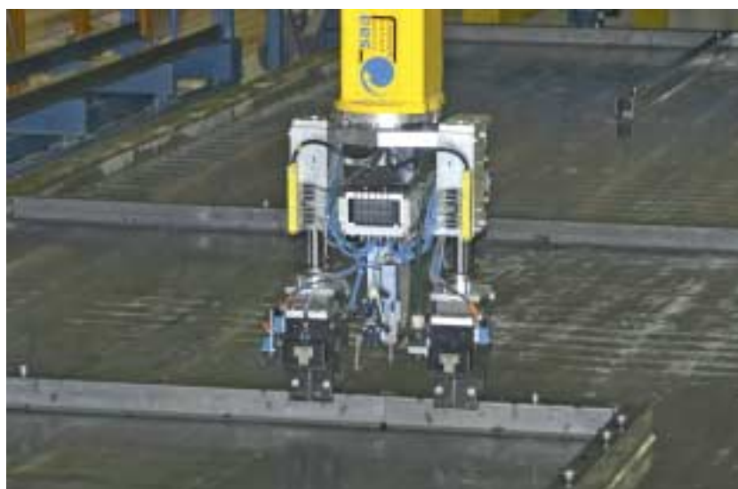
Fig. 2 Proceso de colocación patentado: alinear encofrado, cerrar grietas y activar imán.
