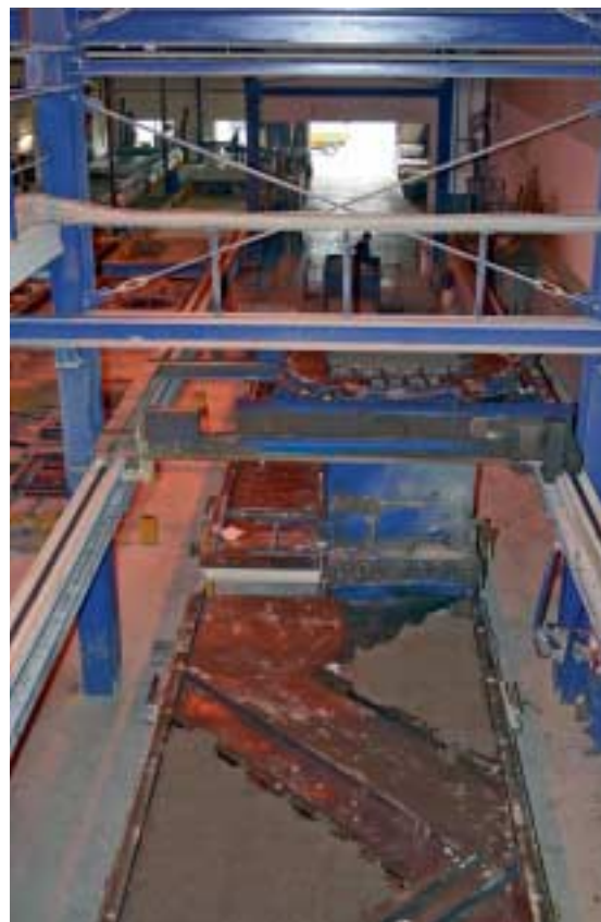
Fig. 9 El palé después de ser llenado, al principio de la fase de compactación.
