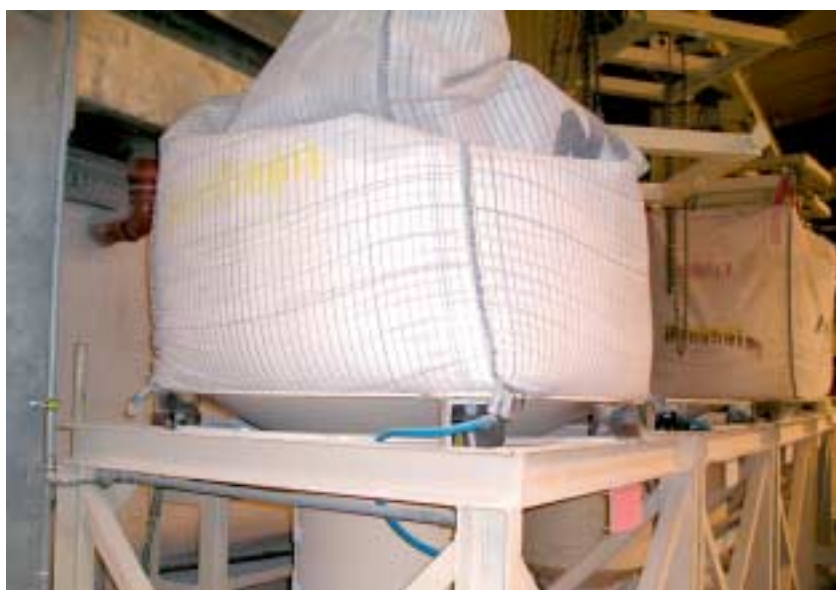
Fig. 4 Los sistemas de vibración fabricados por NetterVibration se utilizan para una gran variedad de fines. Por ejemplo, como ayuda en el vaciado de Big Bags.
