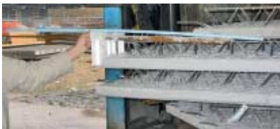
Fig. 17 Conexiones voladizas convencionales en losas prefabricadas.
