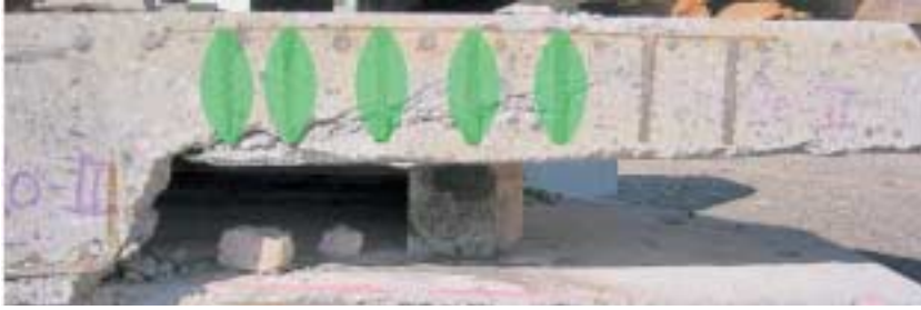
Fig. 5 Muestra de prueba con imagen del modelo de anclaje de compuesto.
