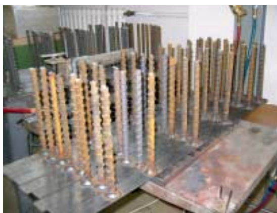
Fig. 4 Barras antipunzonamiento con anclajes de compuesto de alto rendimiento.
