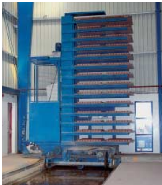
Fig. 8 La plataforma corrediza de la cámara de curado está diseñada como un sistema de doble descarga con 14 estantes.
