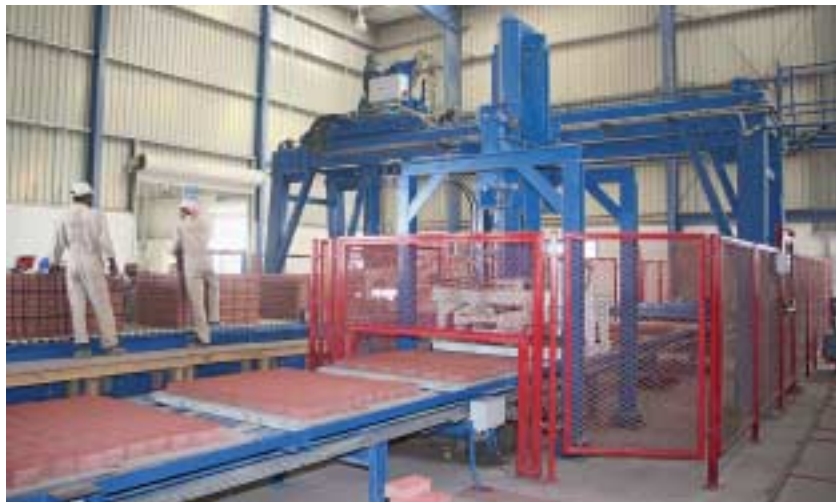
Fig. 9 El lado seco: las capas individuales forman un paquete de bloques, que luego son atados manualmente.
