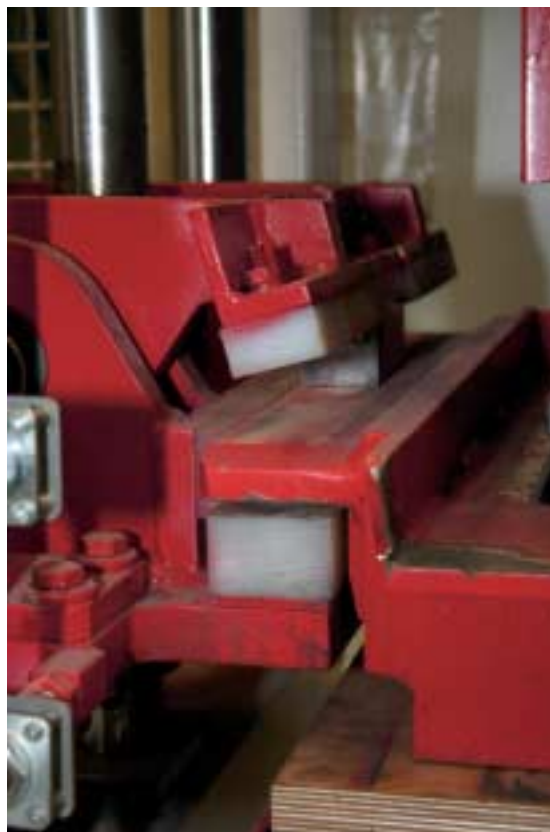
Fig. 3 La abrazadera de moldes desarrollada por Knauer Engineering para la máquina de bloques, a tamaño real.
