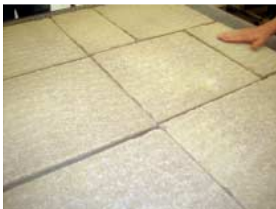
Fig. 1 Varios tipos de losas después de ser envejecidas en el laboratorio de KBH.
