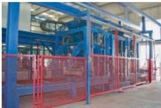
Fig. 7 La máquina de bloques de Frima en FCP está diseñada para tablas de 1.400 x 1.200 mm; las bandejas de producción utilizadas son Wasa-Uniplast.
