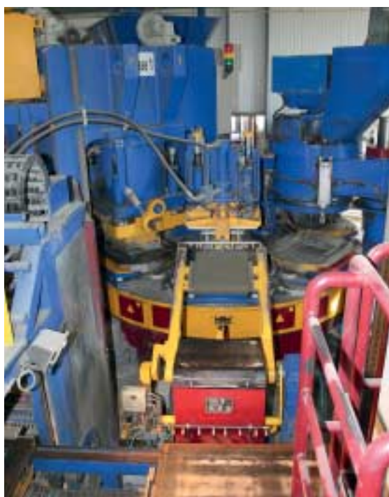
Fig. 7 Se utiliza un agarre al vacío para desplazar las losas desde el molde hasta la placa base.
