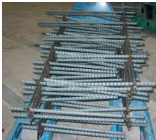
Fig. 8 Armadura de corte de alto rendimiento con forma de escalera para vigas o losas.
