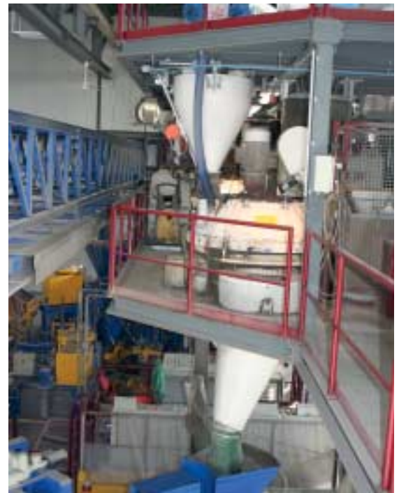
Fig. 4 Segundo y tercer nivel (dosificación, mezcla) sobre las prensas.
