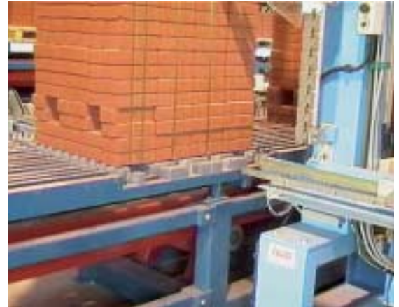
Fig. 15 Flejado de los cubos de bloques.
