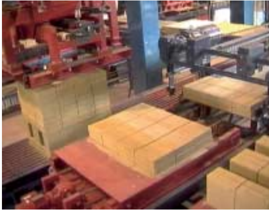
Fig. 14 Capas de bloques preparadas.
