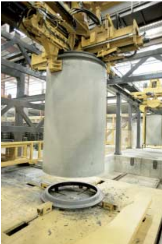
Fig. 8 Extracción de los manguitos.
