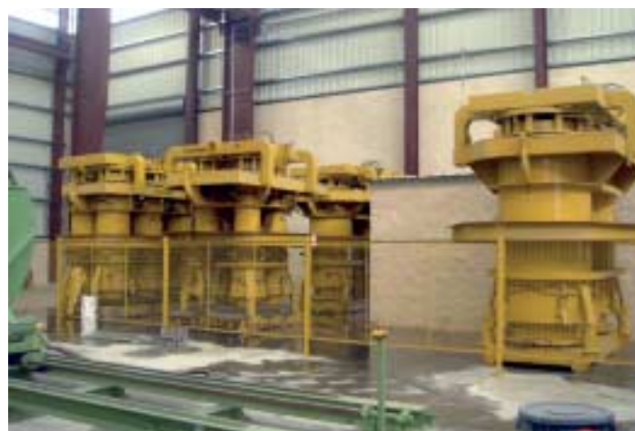
Fig. 3 Con los módulos multiformes con vibradores internos integrados es posible fabricar tuberías de dimensiones diferentes en cada estación.
