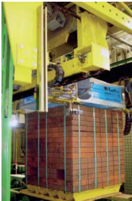
Fig. 5 Los cubos se empaquetan mediante un montador de cubiertas. Fig. 5 Os cubos embalam-se através de um montador de coberturas.
