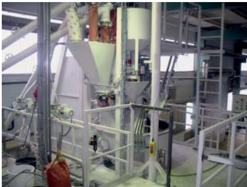
Fig. 1 El mezclador cónico con sistema de pesaje de colores. Fig. 1 Misturadora cónica com sistema de pesagem da cor.
