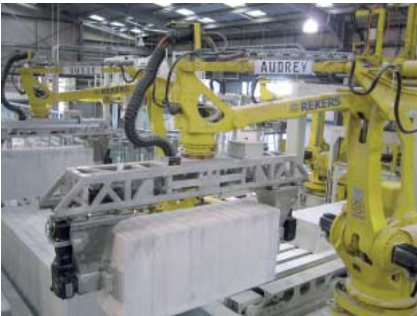
Fig. 4 Unión de los bloques mediante robots.
