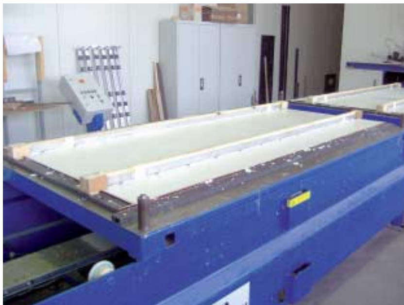
Fig. 6 La Placa hormigonado, con las transversales las cuales fijan las partes de montaje en la posición.
