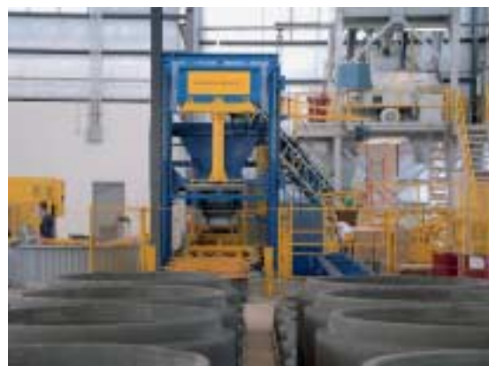
Fig. 3 Producción de elementos de hasta 60" de diámetro interior nominal y hasta 48" de altura eficaz.
