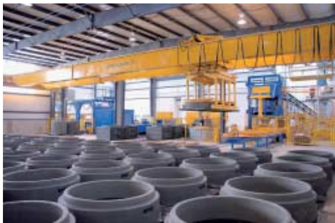
Fig. 4 Manipulación totalmente automática de cualquier tipo de componente.
