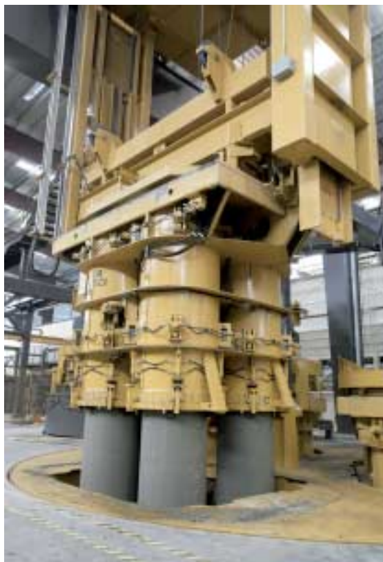
Fig. 4 En la estación de desmoldeo, una grúa agarra las tuberías al completo junto con los moldes, mientras que los núcleos permanecen en el interior de la máquina.
