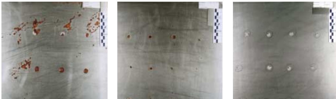
Fig. 10 El test de gotas de agua de sangre – agua de sangre de un hormigón con potencial de encofrado alto (izquierda) ha dotado con cromato: 10 ppm (centro) y 20 ppm (derecho). Adicionado 20 ppm de cromato se ocurre una oxidación insignificante al superficie de acero.
