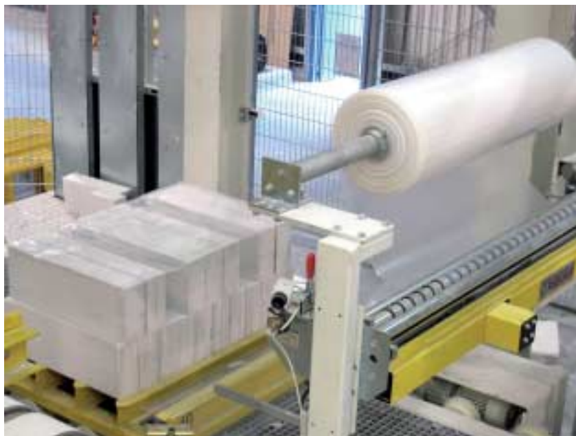
Fig. 5 Distribuidor de la película que confiere estabilidad a la capa hueca.
