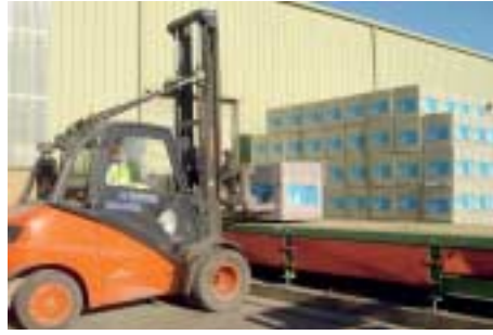
Fig. 7 Transporte del apilador: recogida de un «paquete doble».
