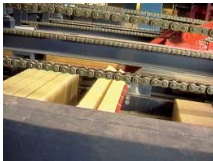
Fig. 13 La estación de colocación vertical de bloques del complejo proceso de reformateado usado por BGC PTY (Australia).
