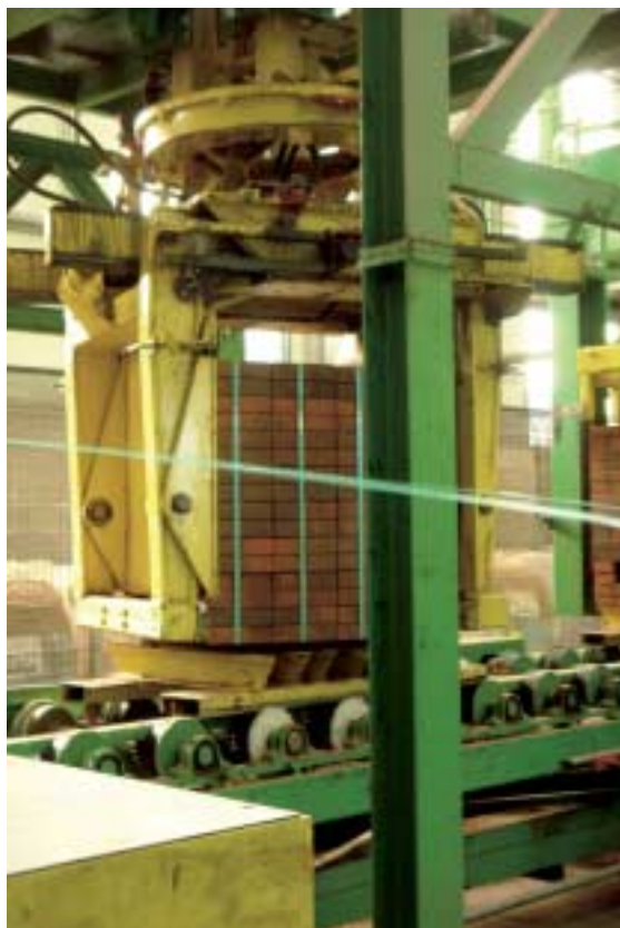
Fig. 4 El cubo se gira para adecuarlo al segundo proceso de flejado. Fig. 4 O cubo roda para de adaptar ao segundo processo de cintagem.
