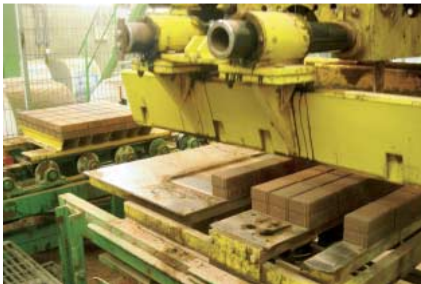
Fig. 3 Formación de espacios vacíos para el transporte posterior con el apilador.
