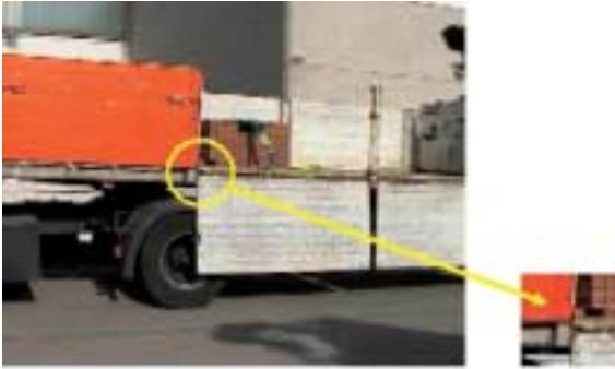
Fig. 5 Una fila de adoquines se ha deslizado hacia delante.
