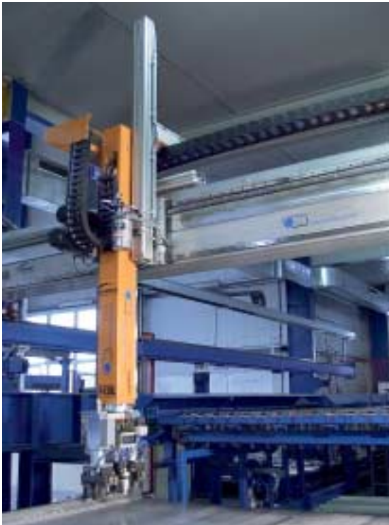
Fig. 7 Ejecución del sistema de ejes.
