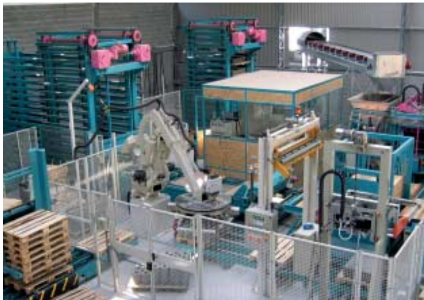
Fig. 1 Robô de empilhamento flexível com servo-pinça numa fábrica de betão).
