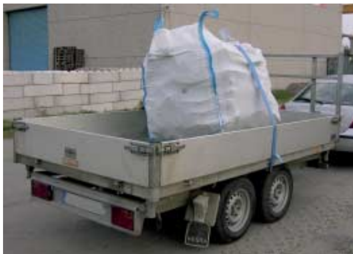
Fig. 1 y 2 Aseguramiento inadecuado de cargas.
