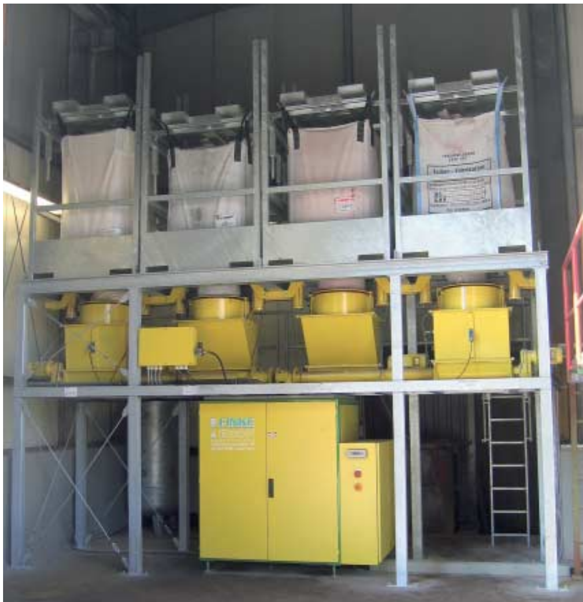
Fig. 2 Sistema neumático de dosificación en polvo de la empresa Finke GmbH para cuatro colores.
