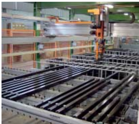
Fig. 1 Depósito de encofrados en la empresa Lösch: El robot durante una operación de almacenaje en el depósito pasivo, en primer plano el depósito activo.
