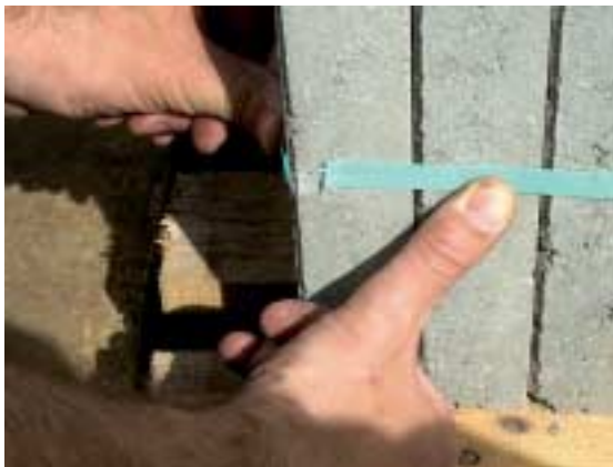
Fig. 7 Cinta de bandaje plástica cortada por los cantos cortantes.
