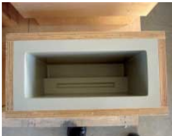
Fig. 2 Molde de resina colada (pie del banco).
