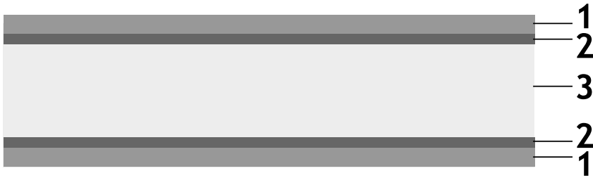
Fig. 2 Las placas alkus están constituidas de una estructura sándwich de cinco capas: 1. Capa superficial de material plástico, 2. Aluminio o fibra de vidrio, 3. Núcleo de material plástico.
