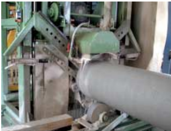
Fig. 5. Extremo macho en procesamiento en el equipo de fresado Fig. 5. Pós-processamento do encaixe na fresadora
