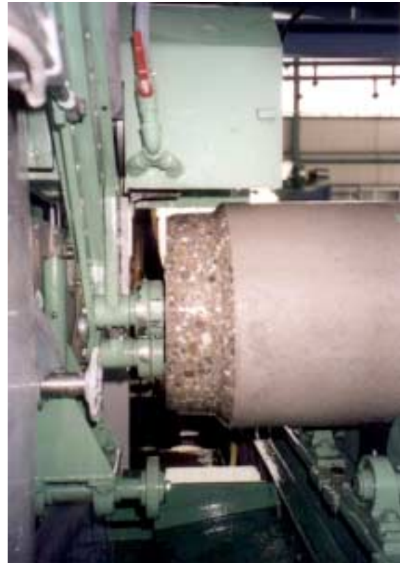
Fig. 4. Extremo macho procesado para sello en manguito Fig. 4. Encaixe processado para a vedação da conexão luva
