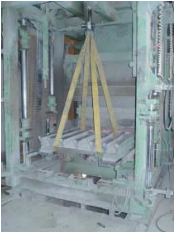
Fig. 2. Desmontaje de los elementos portantes de cargas, alimentación de molde, mesa de vibrado y accionamiento de vibración
