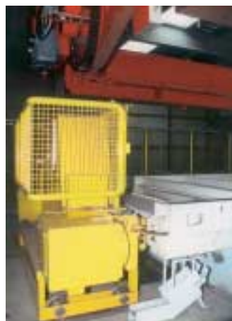
Fig. 4. El equipo para relajación de tensiones se acopla al marco tensor del pallet
