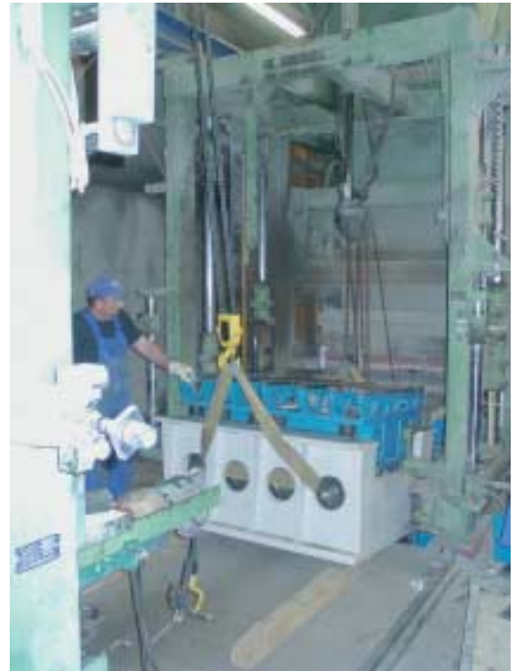
Fig. 5. Montaje de la nueva mesa de vibrado Fig. 5. Montagem da nova mesa vibradora
