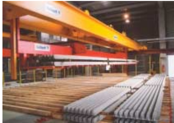
Fig. 7. ... y entrega de tramos completos de vigas de hormigón pretensado Fig. 7. ... e encomenda da viga talhada de betão pré-esforçado
