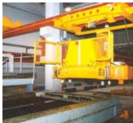
Fig. 10. Fijación de la barra tensora Fig. 10. Fixação do jugo tensor
