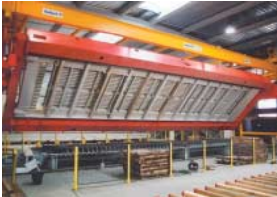
Fig. 3. Agarre y giro de pallet fraguado Fig. 3. Giro da paleta endurecida
