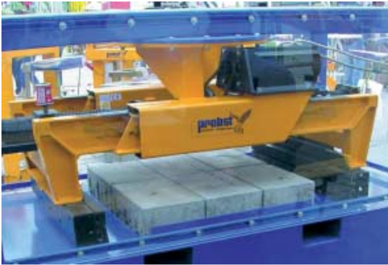
La tenaza de agarre ATZ-E proporciona alta eficiencia con su breve duración del ciclo y su manejo óptimo As pinças elétricas de remoção ATZ-E oferecem alta eficiência através de tempos curtos de ciclos e ótimo manejo
