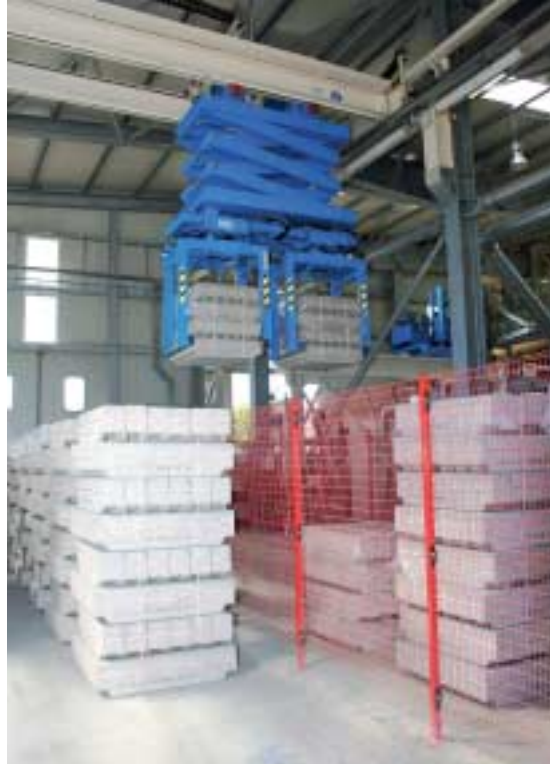
Fig. 9 También se ajusta el puente-grúa a las grandes cargas; puede verse la valla que divide esta sección en dos zonas de almacenamiento.
