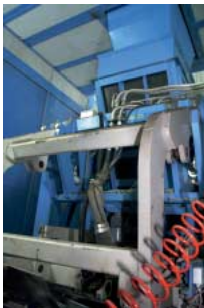
Fig. 3 La máquina de bloques de Weiss Impianti con vibración armónica.
