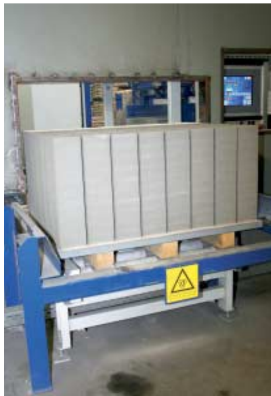
Fig. 6 Una unidad de producción completa que comprende diez capas de bloques se transfiere a la zona en endurecimiento del cubo. Lo que todavía hoy se realiza mediante una carretilla elevadora, en unos meses se realizará por un sistema automático de estantería.
