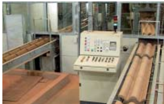
Fig. 2 La sección de tejas manufactureras es transportada a la estación pulverizadora de color.
