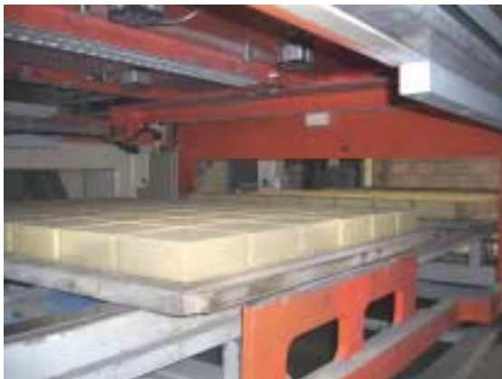
Fig. 6 Después del tratamiento, los adoquines de hormigón se colocan en el sistema de transporte, lo cual se realiza para una capa completa en el ajuste original.
