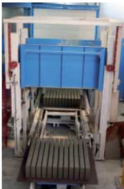
Fig. 4 Producción de bordillos en Special Vibro: estos productos de gran peso son un ejemplo excelente de los beneficios ofrecidos por la vibración armónica.
