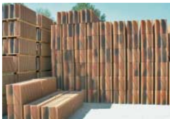
Fig. 4 Los paquetes de tejas son flejados del típico modo italiano.
