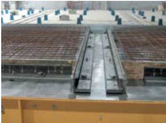
Fig. 4 Pueden utilizarse módulos de acero a medida en varios diseños para formar juntas moldeadas.
