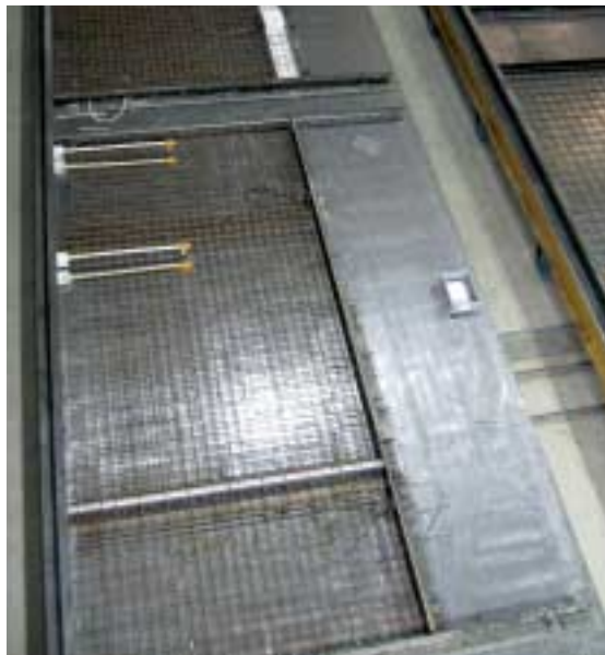
Fig. 1 Cargado del pallet usando el nuevo sistema de encofrado SAS-MF.
