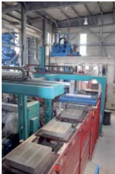
Fig. 7 Línea de transporte y flejado horizontal en el lado seco del ciclo de producción.
