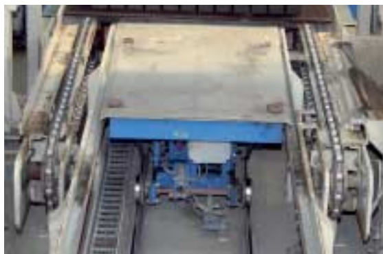
Fig. 5 El sistema de transporte al lado húmedo: los « carrellini » garantizan la alimentación exacta y uniforme.
