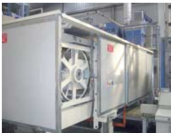
Fig. 5 Una de las dos « curvas del túnel », vista desde el exterior; las ranuras permiten que el polvo salga del sistema. A la derecha puede verse el sistema cerrado.
