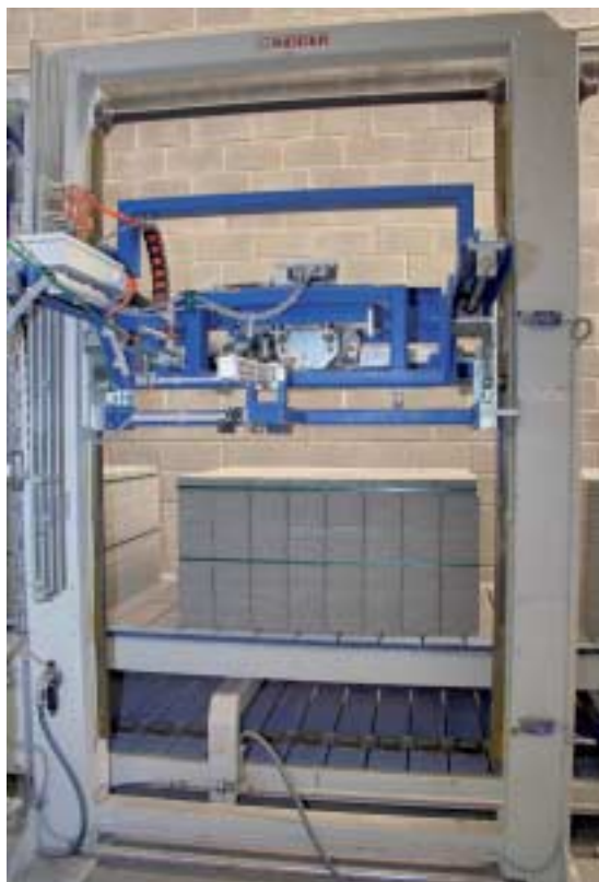
Fig. 8 El cubo de bloques se fleja dos veces en horizontal con banda de PP.
