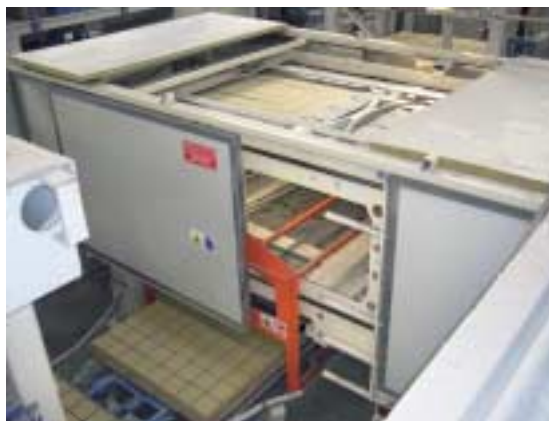
Fig. 4 Vista de la máquina: puede verse la primera placa giratoria en la que se gira la capa 90°.
