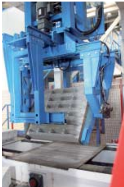
Fig. 6 Con la primera grapa integrada en el lado seco del ciclo de producción, pueden girarse los productos 180°. Los bordillos se giran a la posición de instalación.
