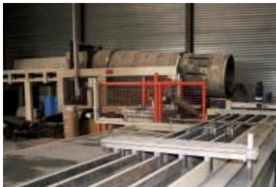
Fig. 1 Hasta ahora, en Windmolders se han envejecido los adoquines de hormigón en un tambor convencional. Debido a un ritmo de producción en aumento, este sistema se utilizará además del nuevo sistema instalado.
