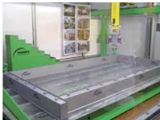
Fig. 8 Robot de cofragem da Sommer.
