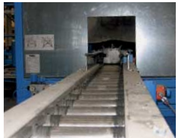
Fig. 7 Colocación de los perfiles de encofrado sobre la cinta transportadora, paso a través del limpiador y aceitador con identificación a continuación y extracción por el robot de encofrado.
