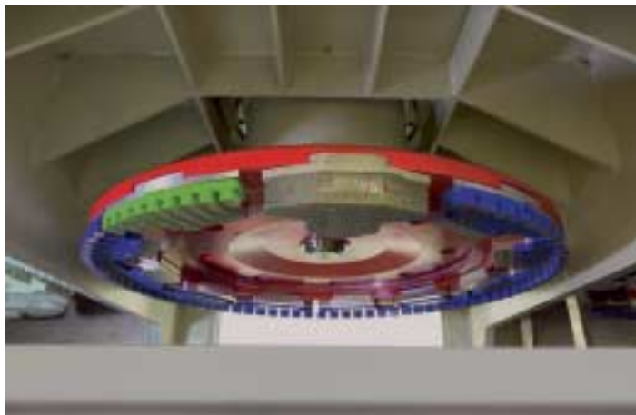
Fig. 5 Estación de pulido con diferentes herramientas de diamante y esmerilado equipada como muestra.
