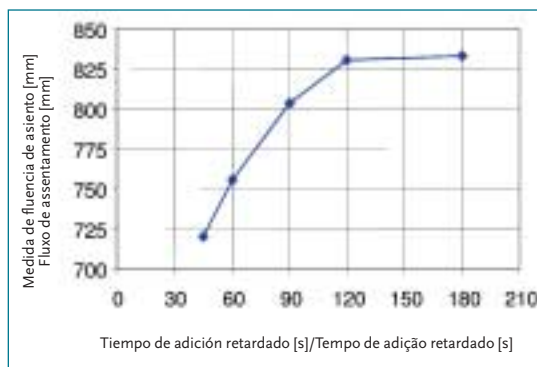
Fig. 5 Influencia de la medida de fluencia de asiento a través de dosificación retardada de aditivo de fluencia.
