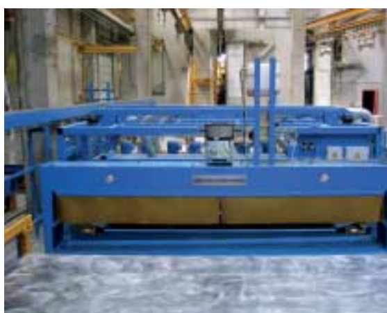
Fig. 3 Limpieza y aceitado automático de las paletas, aplicación parcial de lacas retardantes para la superficie de hormigón visto con el robot de lacado.
