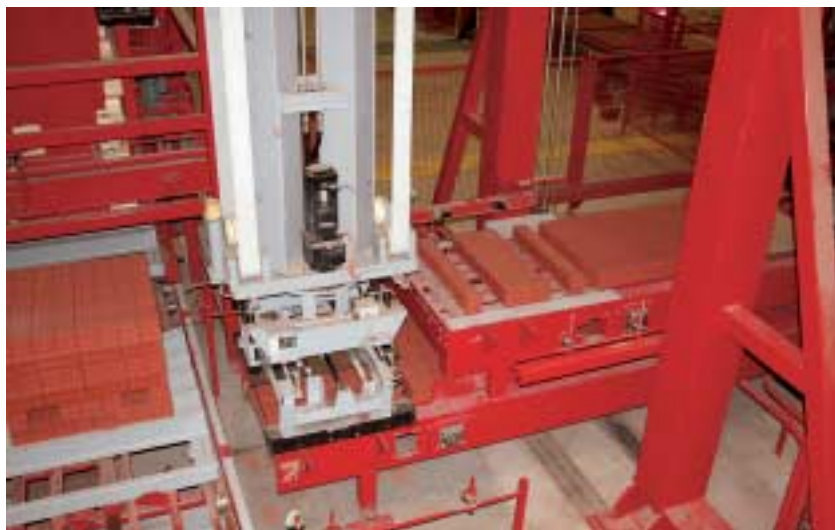
Fig. 6 Empaquetadora servoasistida con combinación de mesas corredizas.
