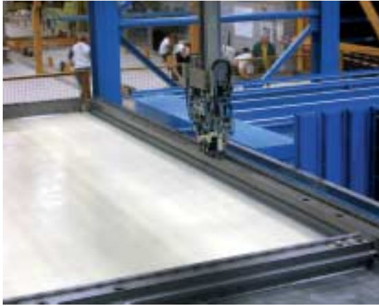
Fig. 4 Encofrado multilateral de la paleta por el robot de encofrado.
