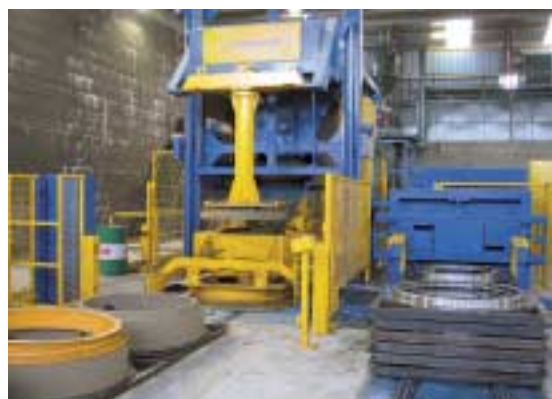
Fig. 2 Vista en detalle de la producción de pozos.
