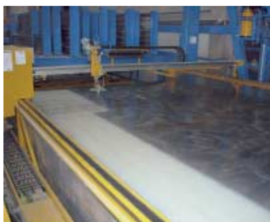
Fig. 3 Limpieza y aceitado automático de las paletas, aplicación parcial de lacas retardantes para la superficie de hormigón visto con el robot de lacado.
