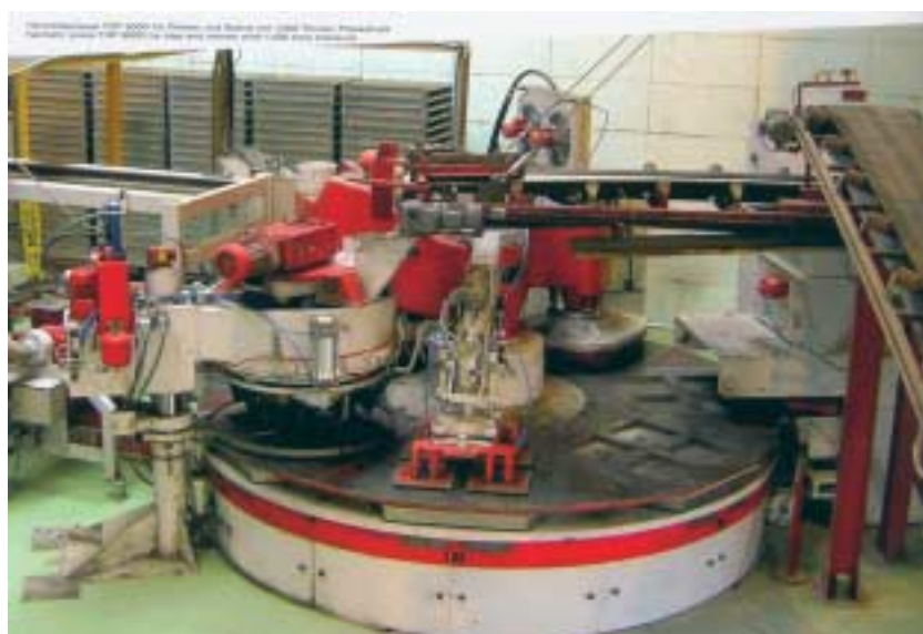
Fig. 3 Prensa hermética SR-Schindler/OCEM TOP 9000.
