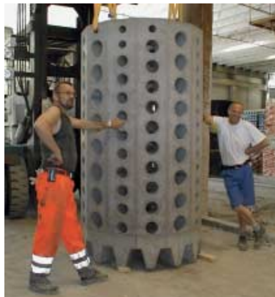
Fig. 6. Elementos de barrera artificiales de SCC. Spenncon AS, Trondheim, Noruega Imagem 6. Componente de recife em BAC, Spenncon AS, Trondheim, Noruega
