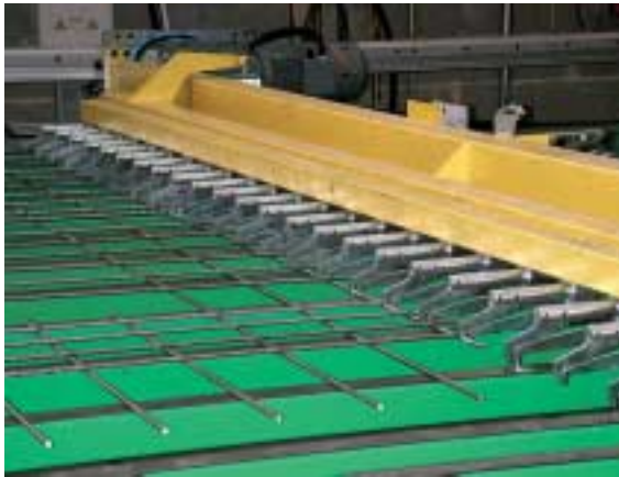
Figura 6. Equipo para posicionado de las unidades en malla para refuerzo Imagem 6. Dispositivo de tracção da esteira para posicionar as esteiras de reforço
