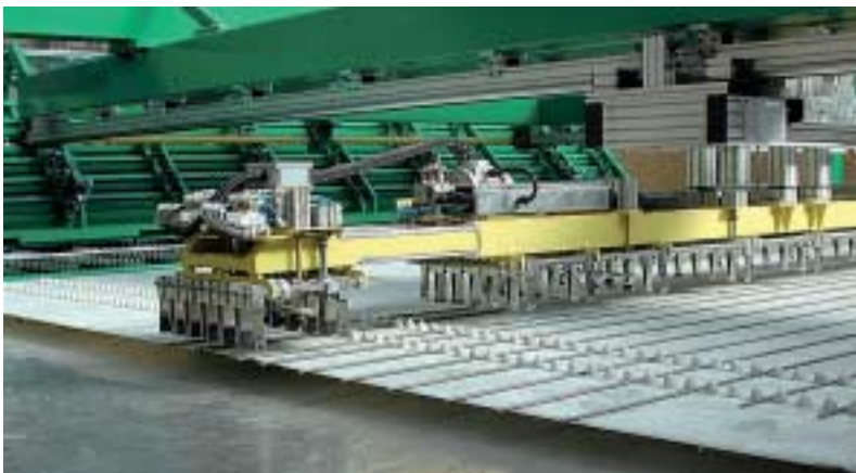
Figura 4. Robot para depósito de barras de refuerzo Imagem 4. Robô de inserção para as barras de reforço
