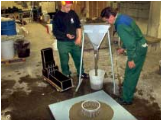
Fig. 3. Pruebas de SCC en el Laboratorio Central de Consolis en Parainen, Finlandia Imagem 3. Teste do BAC no laboratório central da Consolis Parainen, Finlândia
