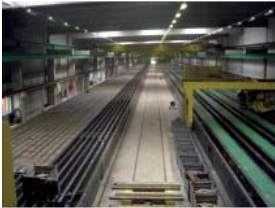
Figura 12 Fabricación de pilotes en una nave de producción de 240 m de longitud Imagem 12. Produção de estacas num pavilhão de produção com 240 m de comprimento
