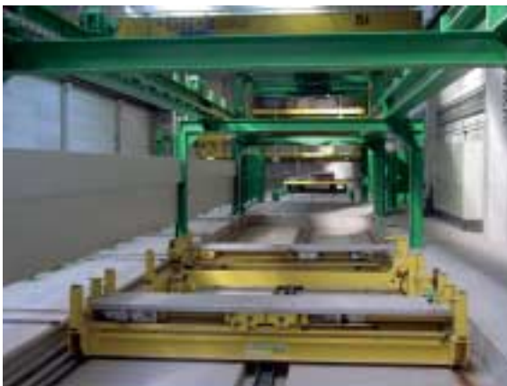
Figura 10. Plataforma de arrastre central para traslación de los pallets Imagem 10. Plataforma de deslocação central para movimentar as paletes
