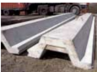
Fig. 5. Tablestacas de SCC en Holanda, Spanbeton BV Imagem 5. Paredes de estacas-pranchas em BAC, na Holanda, Spanbeton BV
