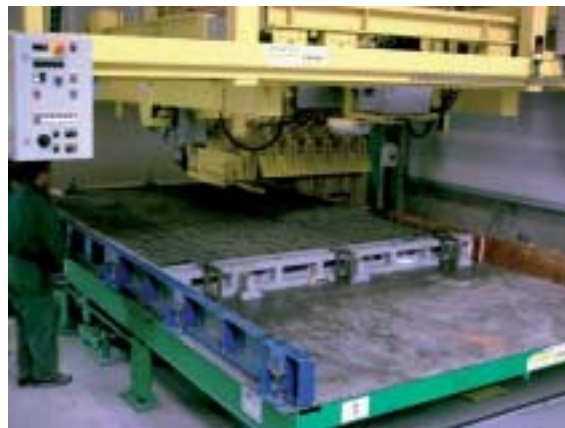
Figura 11. La estación de hormigonado para los pallets Imagem 11. Estação de betoneagem para as paletes
