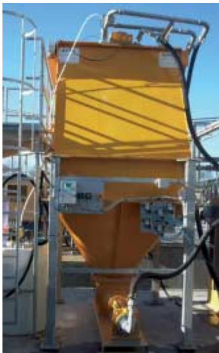
Fig. 5. Sistema de purificación con bomba extractora de sedimentos residuales Imagem 5. Sistema de depuração com bomba de extracção das lamas residuais
