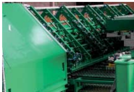
Figura 2. Equipo automático de enderezado y corte de alambre Imagem 3. Máquina totalmente automática de endireitar e cortar arame
