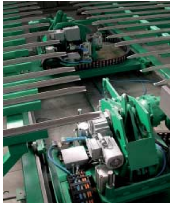
Figura 6. Equipo para posicionado de las unidades en malla para refuerzo Imagem 6. Dispositivo de tracção da esteira para posicionar as esteiras de reforço
