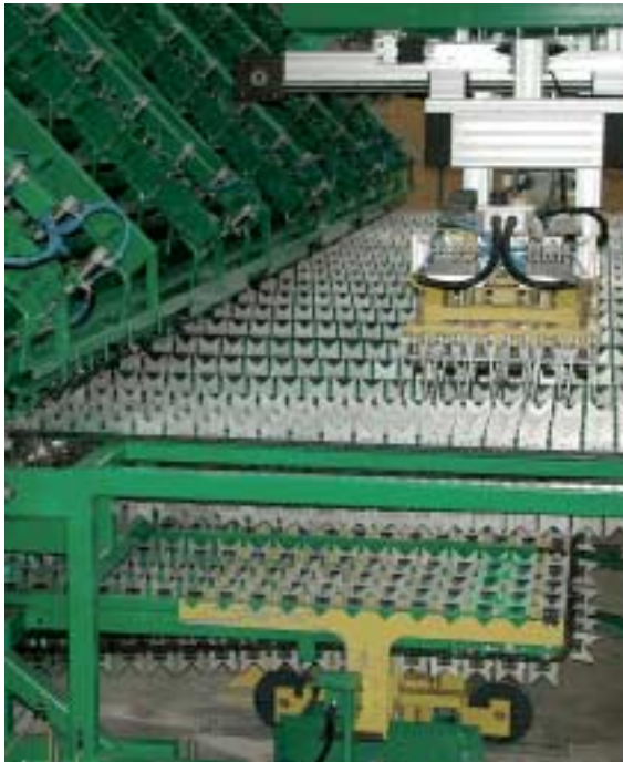
Figura 3. Transportador de cadenas para recogida de las barras transversales y longitudinales Imagem 3. Transportador de correntes para recolher as barras transversais e longitudinais
