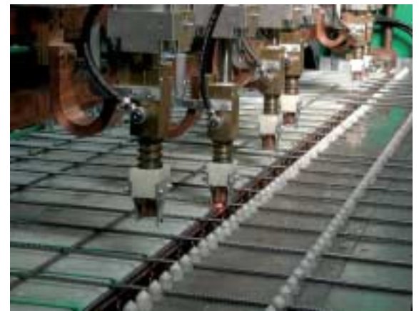
Figura 5. Cabezas de soldadura, também adequadas para diferentes diâmetros de armado Imagem 5. Cabeças de soldar, apropriadas também para diferentes diâmetros de reforço
