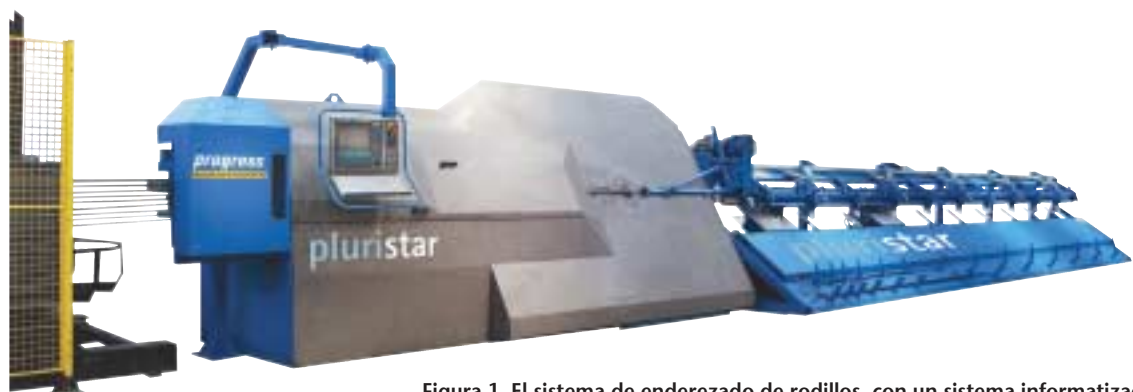
Figura 1. El sistema de enderezado de rodillos, con un sistema informatizado de ajuste de rodillos patentado, se empleó para la elaboración de estribos Imagem 1. Máquina para processamento e transformação de aço para armar betão a partir da bobina, a Progress pluristar
