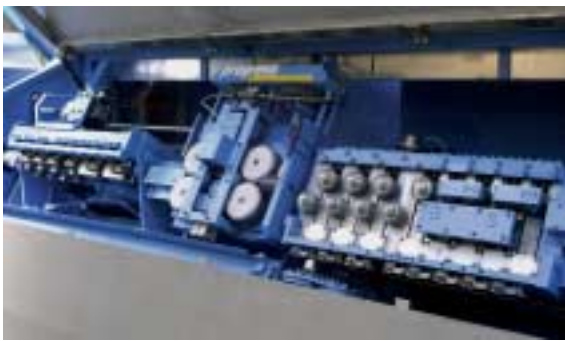
Figura 2. La máquina para la elaboración de acero para armar a partir de bobina, la «pluristar» de Progress Imagen 2. O sistema de endireitar com mecanismo de rolos com sistema patenteado de ajuste de rolos controlado por computador é utilizado na produção de estribos
