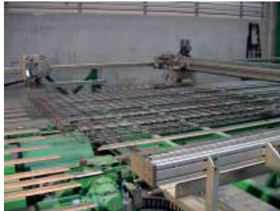
Figura 8. Creación de una jaula de armado tridimensional Imagem 8. Formação da gaiola de reforço tridimensional
