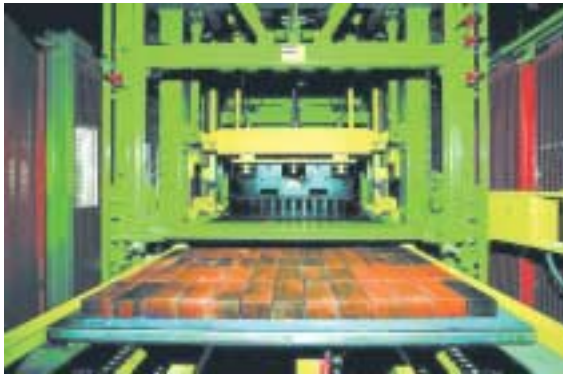
Figura 2. Vista del interior del equipo de bloques Figura 2. Vista da máquina de produzir blocos
