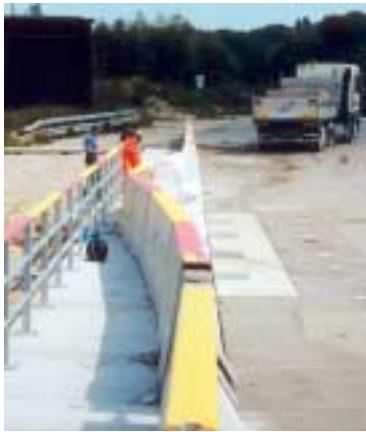
Impacto con un ángulo de 20° de un camión a 65 km/h Colisão de camião a 65 km/h com um ângulo de 20°
