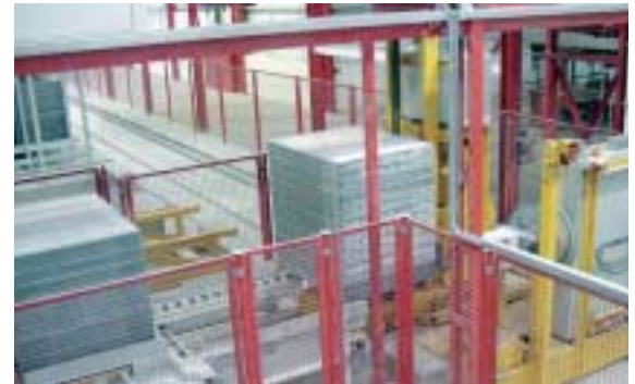
Fig. 7. Carro de transferencia de paquetes de bloques Fig. 7. Grupo de veículos para pacotes de pranchas
