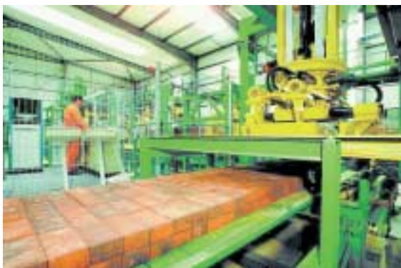
Figura 5. Unidad de duplicación y empuje Figura 5. Duplicador e agrupador
