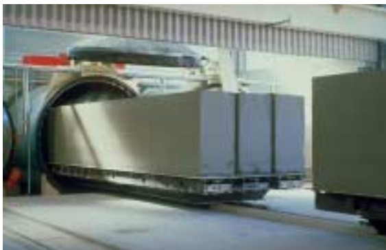
Fig. 4. Producción de hormigón celular (autoclave) Fig. 4. Produção de betão poroso (autoclave)
