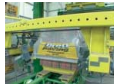
Figura 7. Empaquetado de una de las pilas de bloques Figura 7. Embalagem das pilhas de blocos em película de plástico
