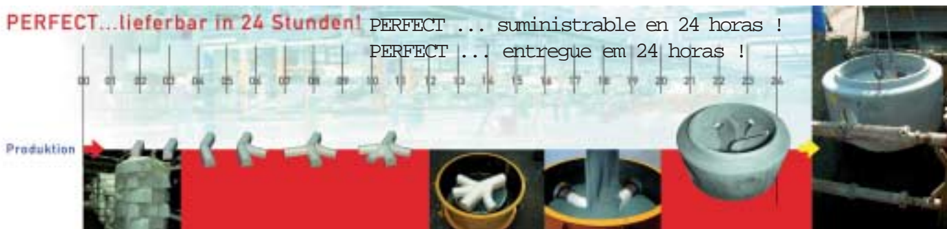
Fig. 4. De las piezas conformadas hasta la parte inferior de pozo completa en 24 horas Fig. 4. Desde a peça de molde, até à parte inferior completa para a caixa de esgoto em 24 horas
