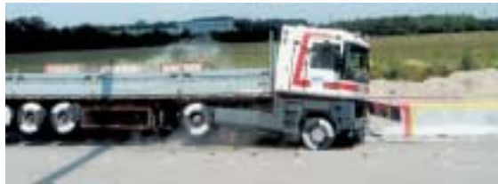
Impacto con un ángulo de 20° de un camión a 65 km/h Colisão de camião a 65 km/h com um ângulo de 20°
