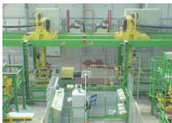
Figura 9. Verjas para protección del personal Figura 9. Vedações para a segurança dos colaboradores
