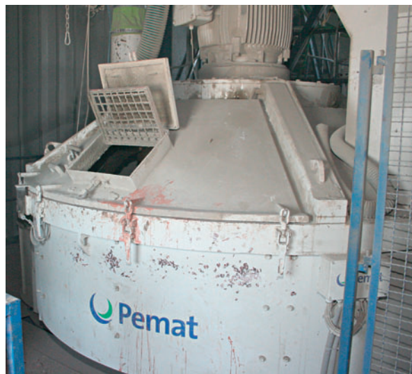
Смесительная установка для бетона компании Pemat.
