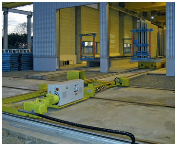
1 Трёхрельсовая передвижная платформа (на переднем плане) принимает стеллаж с двойными стеновыми блоками (на заднем плане) из цеха
