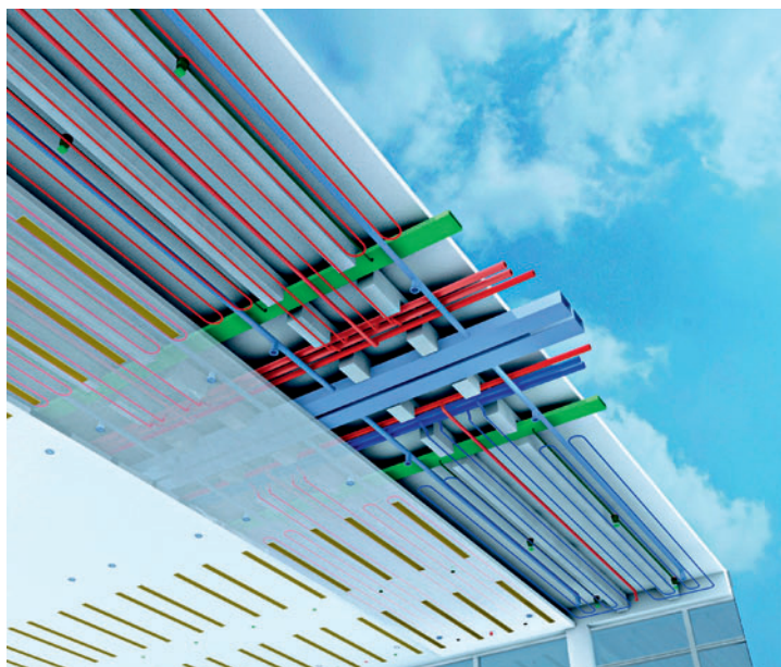
Схематическое представление перекрытия Ceiltec B
