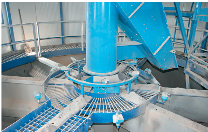
Внешний вид силоса для заполнителя. Сортировка заполнителя осуществляется с использованием вибратора.
