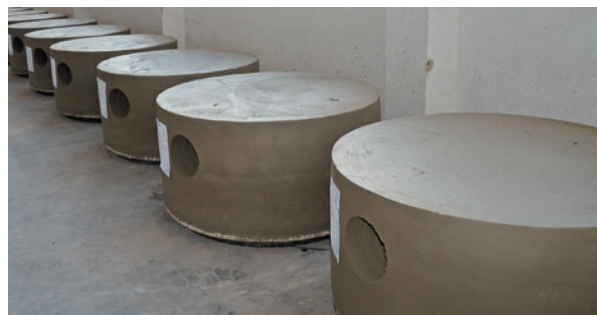
3 Днища шахтных колодцев в производственном цеху.
