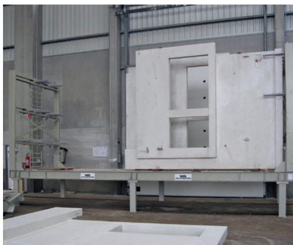
6 Транспортировочный каркас с боковой удерживающей решёткой
