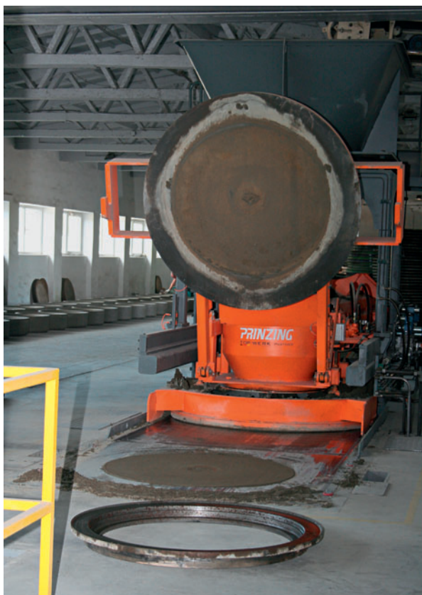
1 Производство днищ шахтных колодцев осуществляется на оборудовании Atlas.
