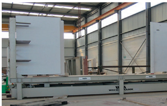
4 Транспортирующая тележка на аккумуляторах с транспортировочным каркасом для высококачественных сборных бетонных изделий
