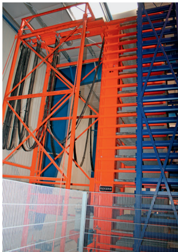
Транспортный участок управляется через прицепной кабель.
