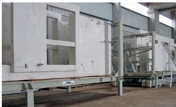
5 Транспортировочный каркас и под ним транспортирующая тележка на аккумуляторах
