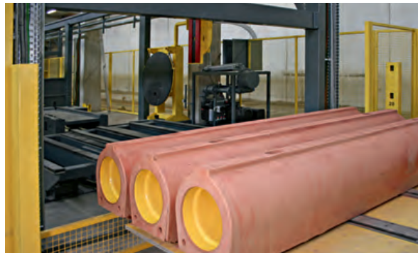
7 Все еще находящийся внутри трубы стальной сердечник – с недавно разработанным механизмом расширения – теперь автоматически выдвигается.
