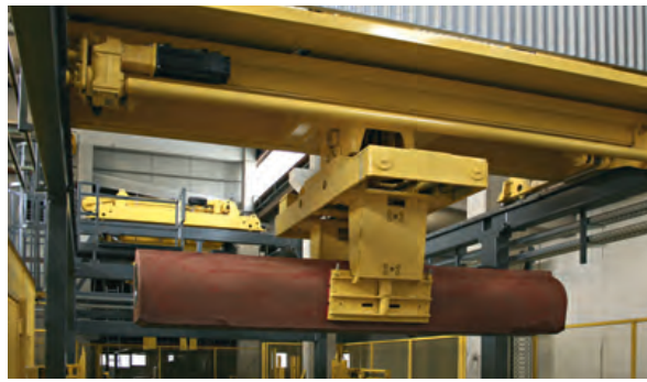
6 После автоматического открытия формы продукцию берёт на себя еще один робот.
