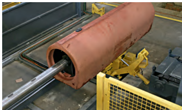
8 Продукция после снятия опалубки попадает на линию вакуумных испытаний в соответствии с номинальными размерами размещается в пакетах на разгрузочном конвейере и вывозится из цеха.
