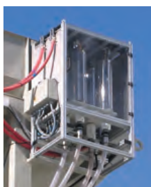
Весы для химических добавок к бетону AC 15/15/15/15 для 8 добавок с 4 цилиндрами
