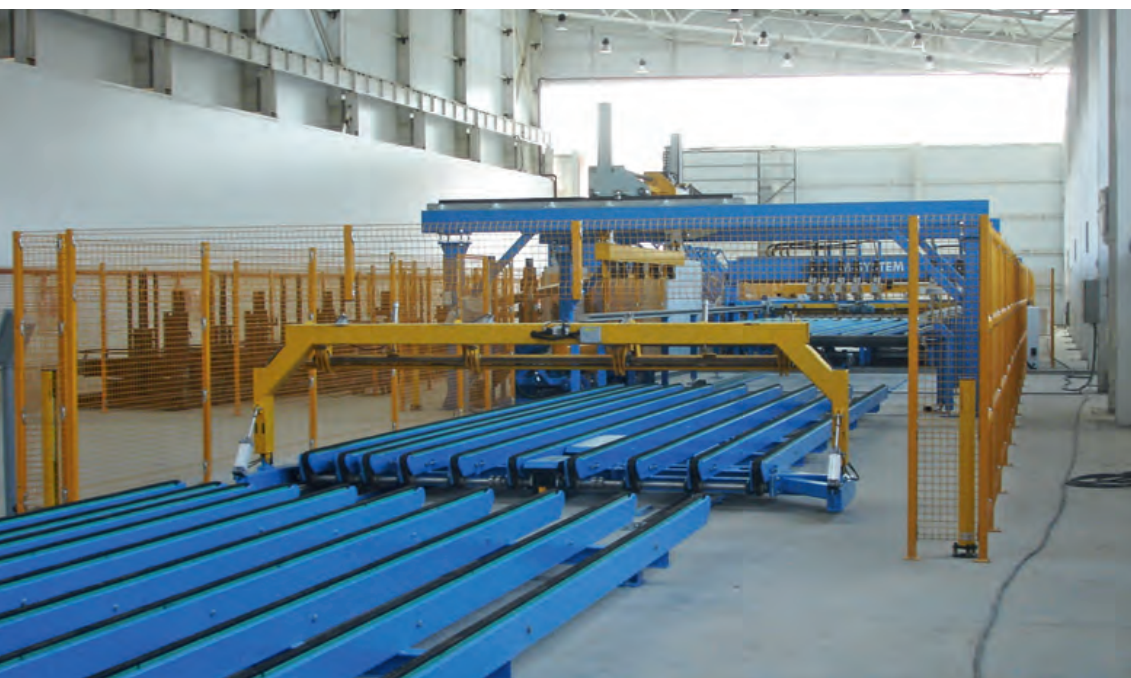
Компания Progress поставила машины для сварки арматуры
