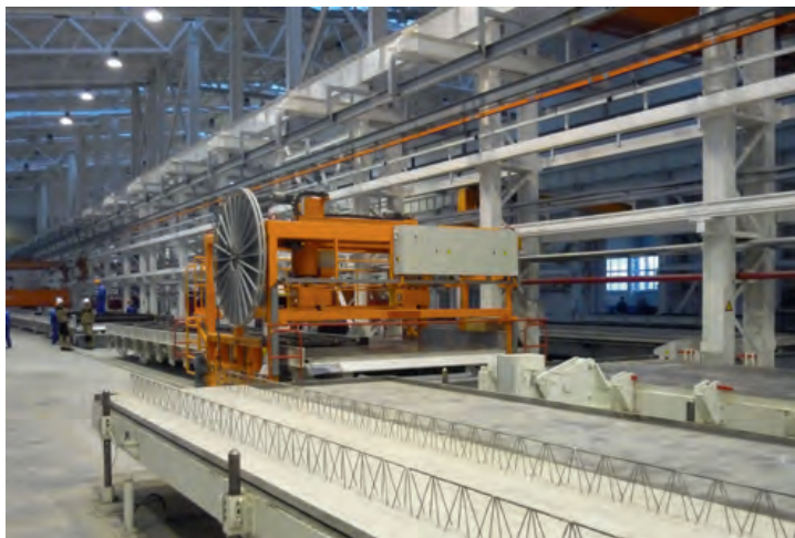
Вид одного из двух производственных цехов, который оборудован опрокидывающими столами, складными поддонами и лопастными заглаживающими устройствами
