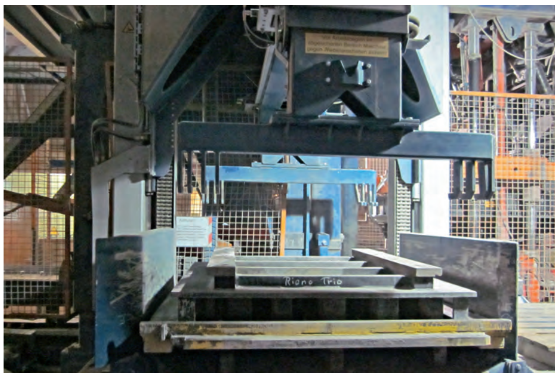
Новое устройство по замене форм компании KBH позволяет осуществить замену формы всего за 100 секунд
