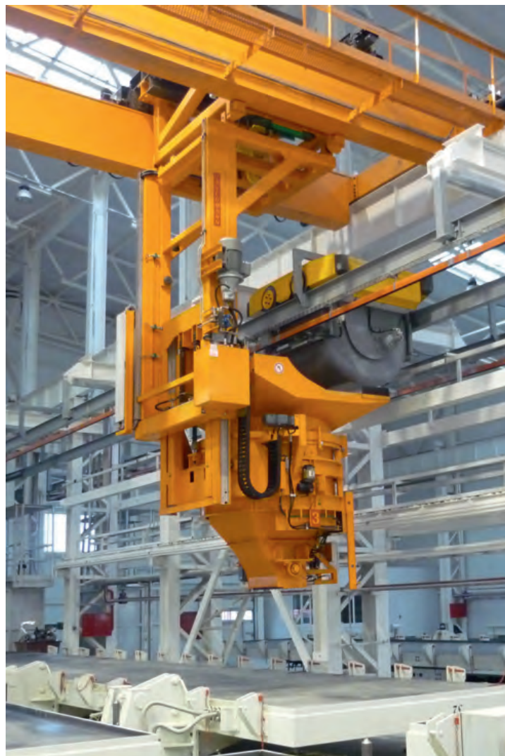
Подача бетона с помощью ковшового конвейера в любое место внутри производственного помещения
