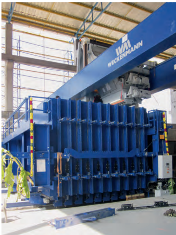
Нагревающиеся трубы в десяти секциях батарейной опалубки ускоряют процесс набора прочности.
