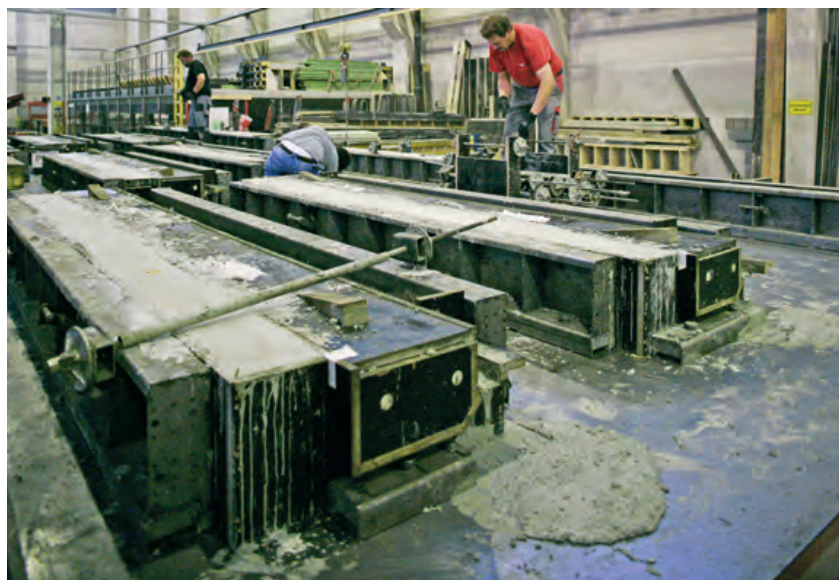
Распалубка готовых сборных изделий для проекта в городе Бругг / Виндиш.
