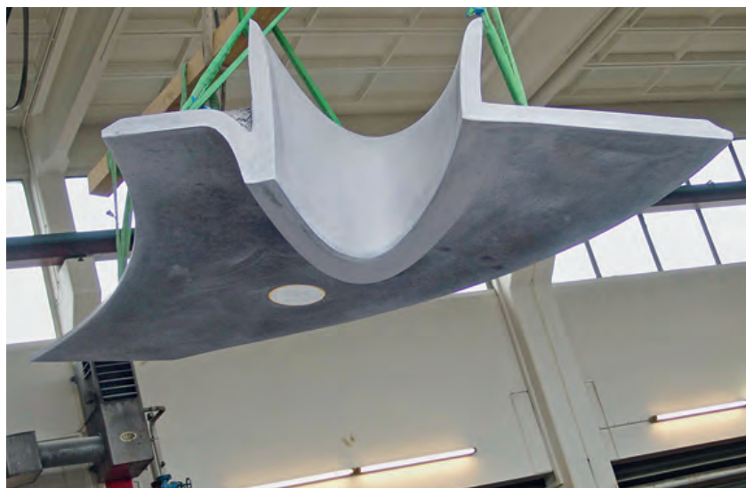
Сборные изделия должны быть очень легкими. Здесь представлен элемент перекрытия.
