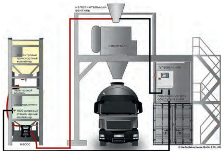
Схема мобильной дозировочной установки для окрашивающих составов
