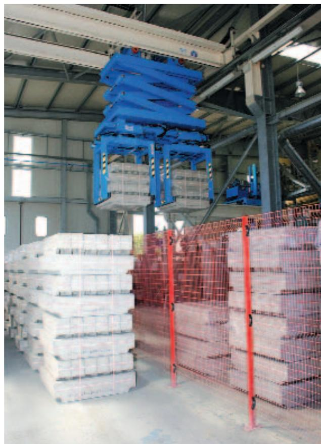
**Рис. 10** Мостовой кран также подобран под тяжелые грузы; заграждение разделяет этот участок цеха на две области временного хранения.
