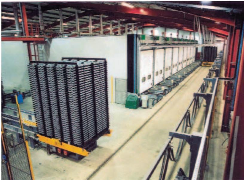
Рис. 3 Система затвердевания Matrix.
