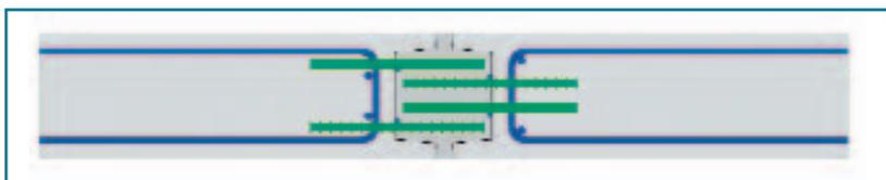
**Рис. 15** Соединение панелей стен при помощи высокоэффективной комбинированной арматуры.
