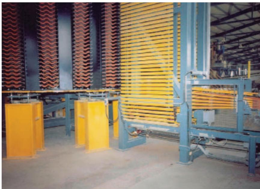
Рис. 4 Пакеты, сформированные в ротационной сушильной установке с функцией нанесения акрилового покрытия.
