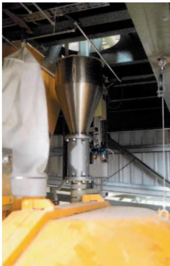
Рис. 1 Весы для порошковых продуктов тип PW 100 с разгрузкой под собственным весом непосредственно в бетоносмеситель.
