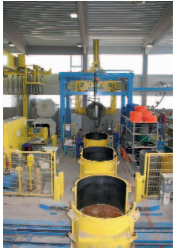
Рис. 12 Станция переворота колец с днищем.
