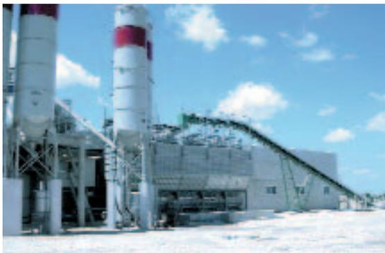
**Рис. 11** Загрузка материалов для наружного бетона в меньшие бункеры.
