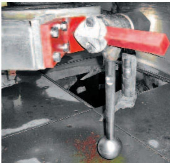
**Рис. 2** Viscprobe, установленный на смесительной звездочке планетарного смесителя Couvrot емкостью 1,5 куб. м на предприятии SBP (Samer – Франция).
