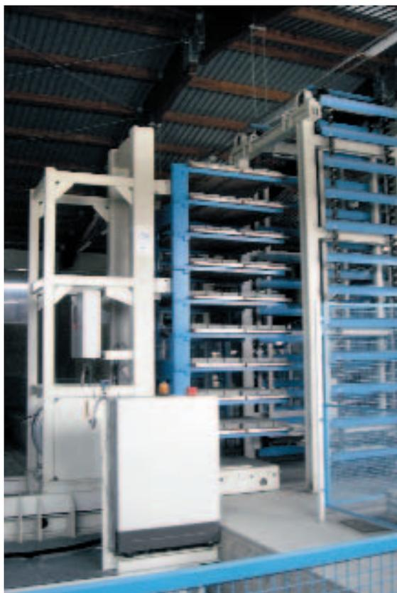
**Рис. 20** Полностью автоматизированная переда- точная тележка с лазерным измерителем.
