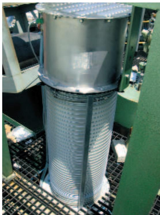
**Рис. 8** Фильтр-циклон для гранулированных пигментов типа CF 40, используемый на одном из смесителей на фирме Jessor в Южной Африке при окрашивании черепицы.
