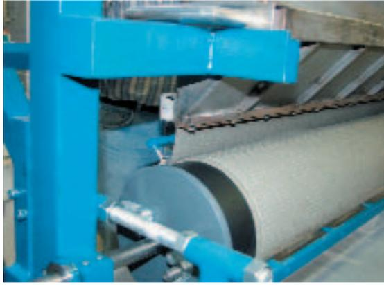
Рис. 5 Калибровка толщины стенки трубы.
