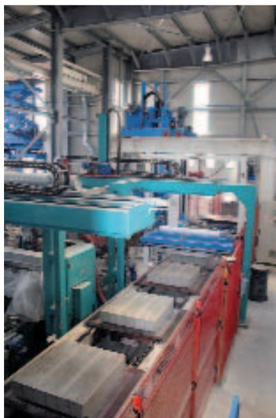
**Рис. 8** Транспортировочная линия и горизонтальная обвязка на сухом этапе производственного цикла.
