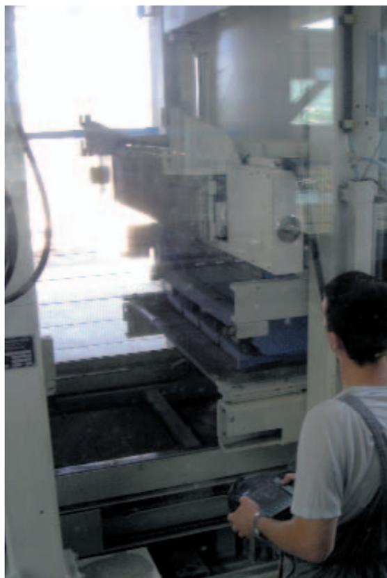
**Рис. 14** Полуавтоматическая замена формы.
