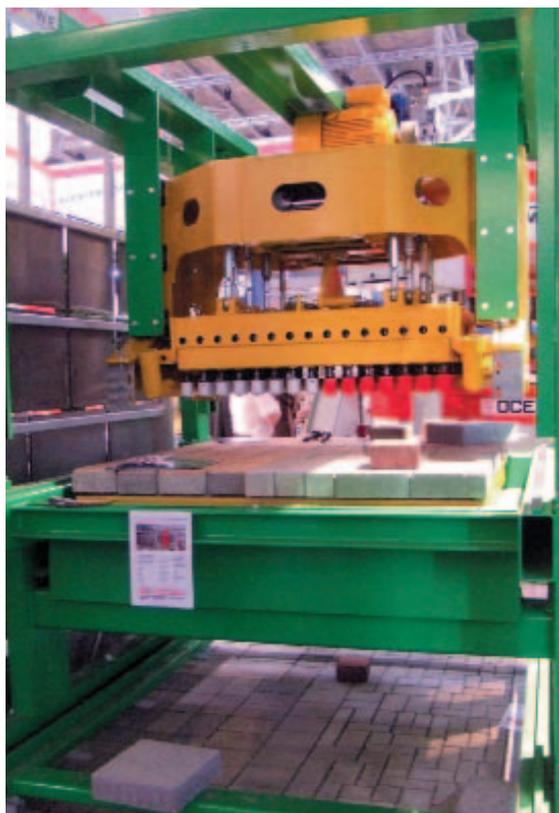
**Рис. 9** SR-Schindler: машина для обработки бучардой.
