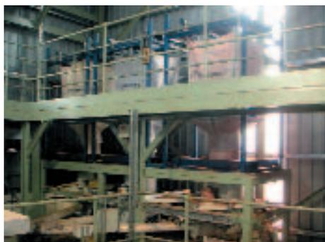
**Рис. 2** Шнековые питатели для дозирования порошковых пигментов из биг-бэгов в весоизмерительную емкость.
