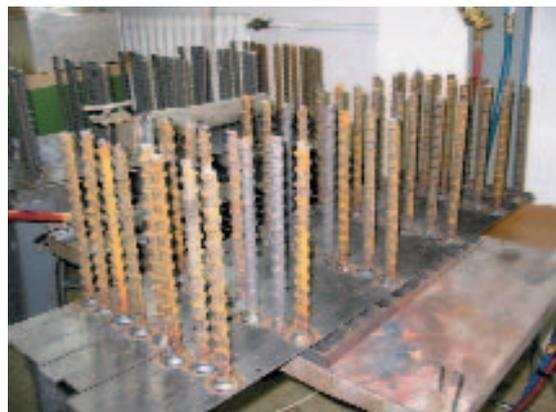
**Рис. 4** Предотвращающие продавливание стержни арматуры с высокоэффективными комбинированными анкерами.
