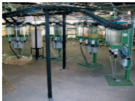
**Рис. 4** Весы для взвешивания жидких пигментов типа KFW, каждые с тремя цилиндрами.
