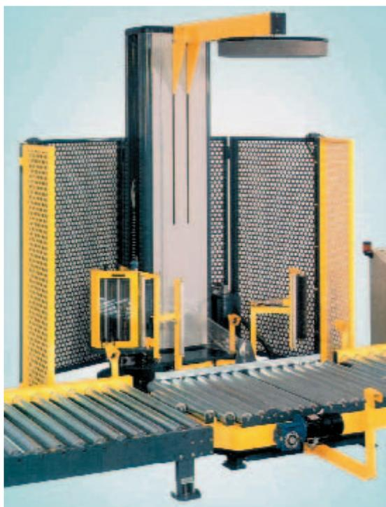
**Рис. 4** Автомат для обертывания в растягивающуюся пленку WS 46 — это высокоэффективная машина кругового действия, которая находит применение не только в строительной промышленности.
