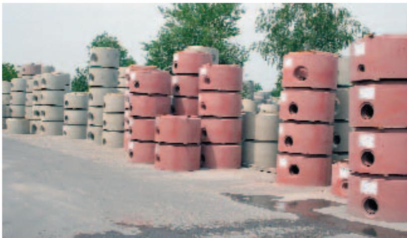
**Рис. 1** Склад в Тайзинге. В компании Haba Beton, красный цвет означает, что кольцо с днищем выполнено из бетона высокого качества с повышенной удобоукладываемостью (С60/75), а также выделяет товар высшего качества.
