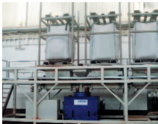
**Рис. 7** Пневматическая система для дозирования порошковых пигментов типа FLEX 70, используемая на смесительной установке фирмы Kniele в Румынии для окрашивания черепицы.
