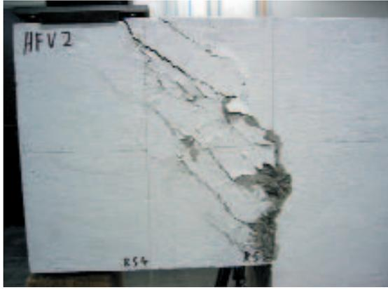
**Рис. 11** Картина разрушения консоли с высокоэффективным комбинированным армированием элемента, работающего на растяжение.
