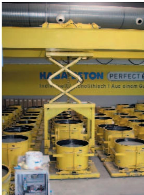
**Рис. 9** Портальный подъемный кран-робот для транспортировки готовой к заливке или загруженной опалубки.
