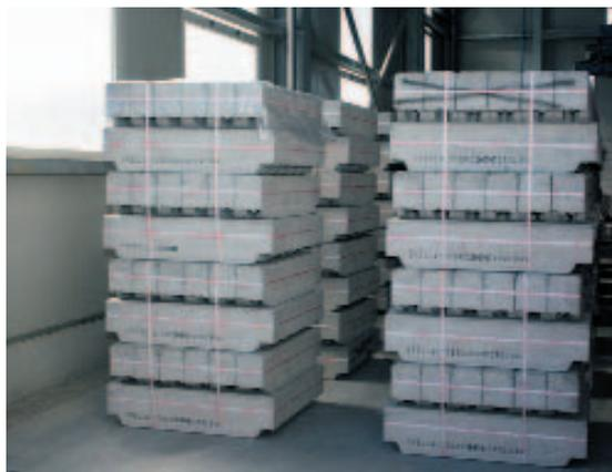
**Рис. 2** Благодаря специальной форме бордюрного камня, поддоны для отгрузки не требуются.
