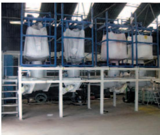
**Рис. 5** Установка для дозирования и смешивания с водой порошковых пигментов типа TFW 90 с четырьмя шнековыми питателями типа PB 120, установленная на фирме Armstrong в Великобритании для окрашивания тротуарной плитки.
