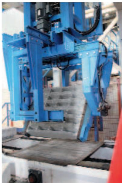
**Рис. 7** Первый захват на сухом этапе производственного цикла позволяет развернуть изделия на 180°. Бордюрный камень переключается в монтажное положение.
