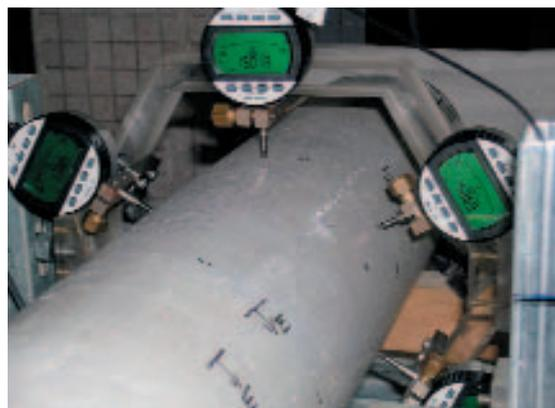
**Рис. 8** Стенд для испытания внутренним давлением [2].
