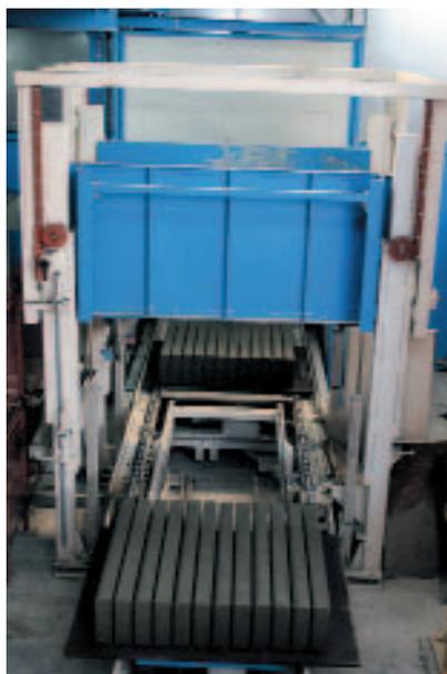
**Рис. 4** Машина для изготовления блоков с гармонической вибрацией производства Weiss Impianti.
