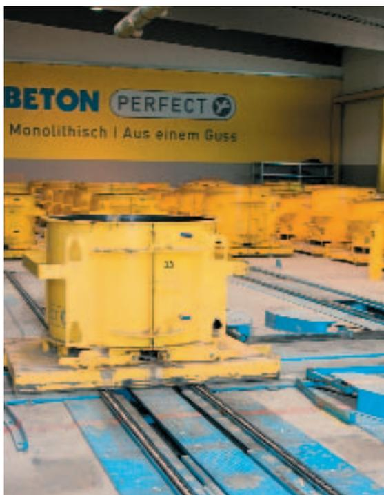
**Рис. 8** Формы транспортируются на цепном конвейере от распалубочного участка к месту сборки опалубки, а затем на участок заливки бетонной смеси.
