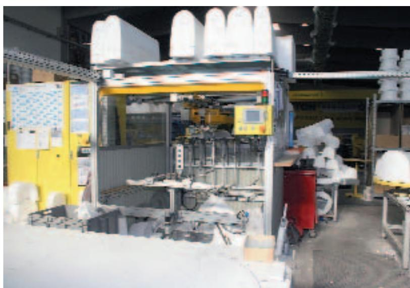
**Рис. 5** С помощью нагретых струн пенополистирольные элементы нарезаются согласно требованиям – в данном случае, для производства трехмерных, округлых сочленений.
