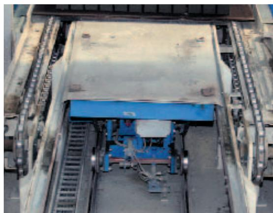
**Рис. 6** Транспортировочная система на сыром этапе: устройство "carrellini" гарантирует точную и равномерную подачу.
