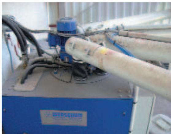
**Рис. 6** Установка для дозирования и смешивания с водой порошковых пигментов типа TFW 90.
