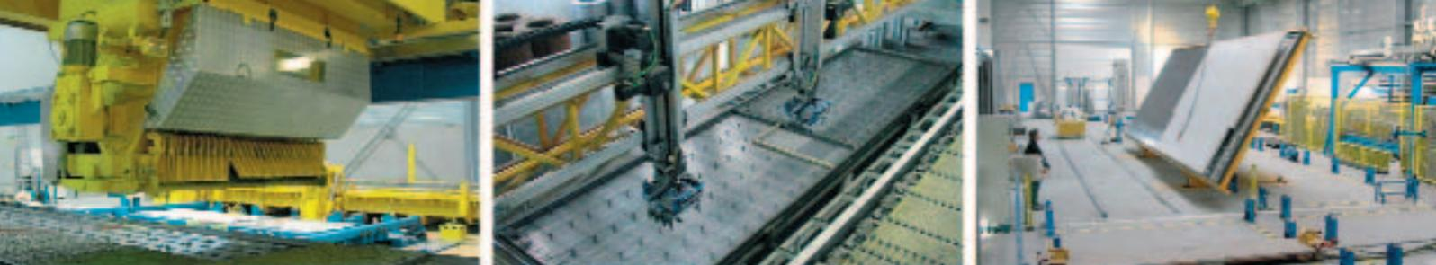
Системы циркуляции паллет EBAWE для производства стеновых панелей, сэндвич-панелей и перекрытий - конструирование, проектирование, реализация.
