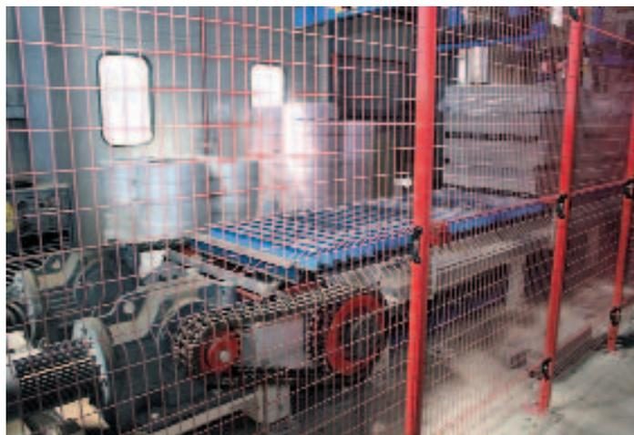
**Рис. 9** Пластинчатый конвейер: ввиду больших нагрузок здесь также потребовалось особое решение.
