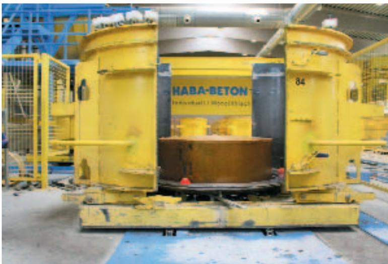
**Рис. 7** Открытая опалубочная форма до вставки пуансона.
