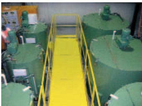
**Рис. 3** Емкости-смесители типа MDI 1000 и MDI 2000 используемые для окрашивания черепицы, Флорида/США.
