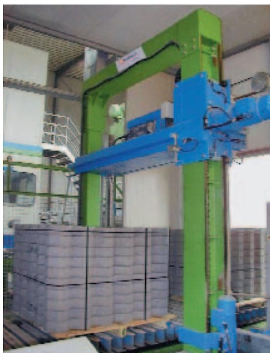
Рис. 2 Вертикальная обвязочная машина vario master 9470 превосходно обвязывает пакет изделий, расположенный на стандартном или специальном поддоне, а также в контейнере.
