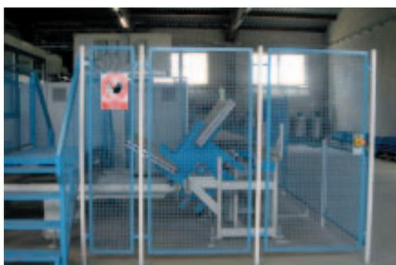
**Рис. 22** Так называемый "Z-образный кантователь" и перекладка поддонов на поперечную транспорти- ровочную линию.
