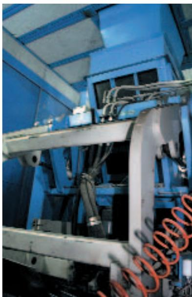
**Рис. 5** Производство бордюрного камня на фирме Special Vibro: эти высокие, тяжелые изделия – яркий пример достоинств, обусловленных гармонической вибрацией.
