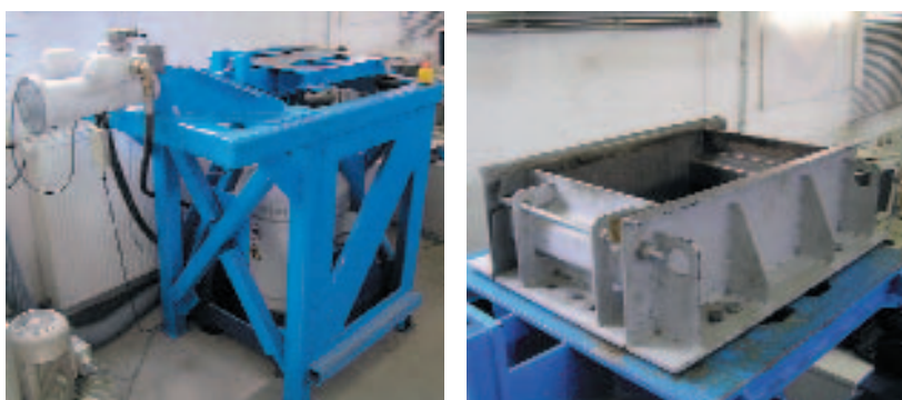
Рис. 11 Лабораторный испытательный стенд для многонаправленной вибрации (слева) и экспериментальная форма (справа).
