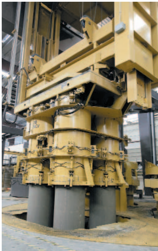
Рис. 4 На распалубочной станции кран захватывает всю партию труб вместе с формой, при этом сердечники остаются в установке.
