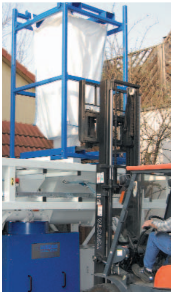
Рис. 4 Одно из преимуществ системы – низкая рама, обеспечивающая простоту погрузки.
