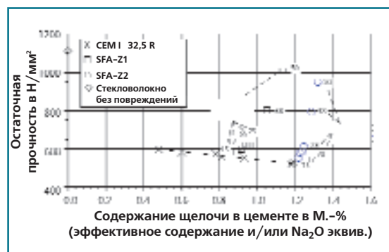
Рис. 7 Прочность стекловолокна на разрыв при использовании цементов типа CEM I 32,5 R с различным содержанием щелочи (остаточная прочность).
