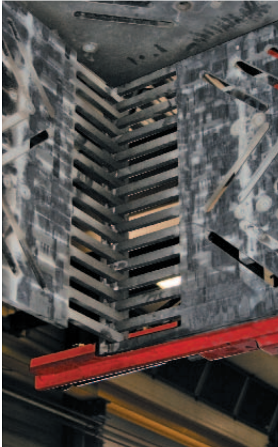
Рис. 6 Угол корзины в деталях: стенки корзины соединены между собой посредством взаимоблокирующихся профилей; размер корзины может быть легко изменен.
