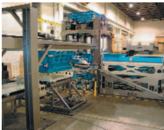
Рис. 2 Система автоматической замены форм.
