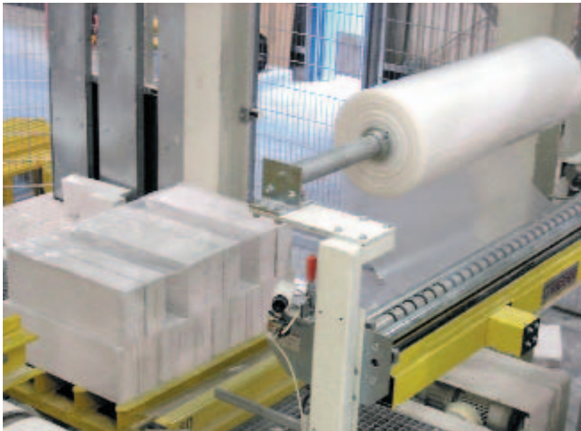
Рис. 5 Раздатчик пленки для закрепления слоя с пустотами.
