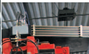
Рис. 3 Штабель плит перемещается под корзину и затем загружается в нее при помощи подъемника.
