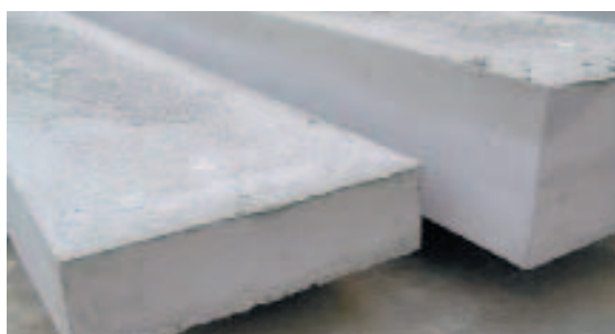
Рис. 24 Сборные бетонные конструкции, изготовленные на опытном образце.
