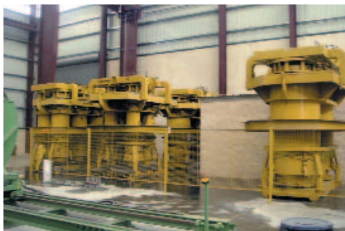
Рис. 3 Принцип применения модулей из нескольких форм со встроенными центральными вибраторами позволяет выпускать трубы разного типоразмера на каждой станции.
