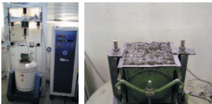
Рис. 10 Лабораторный испытательный стенд для однонаправленной вибрации (слева) и экспериментальная форма с бетонной смесью (справа).
