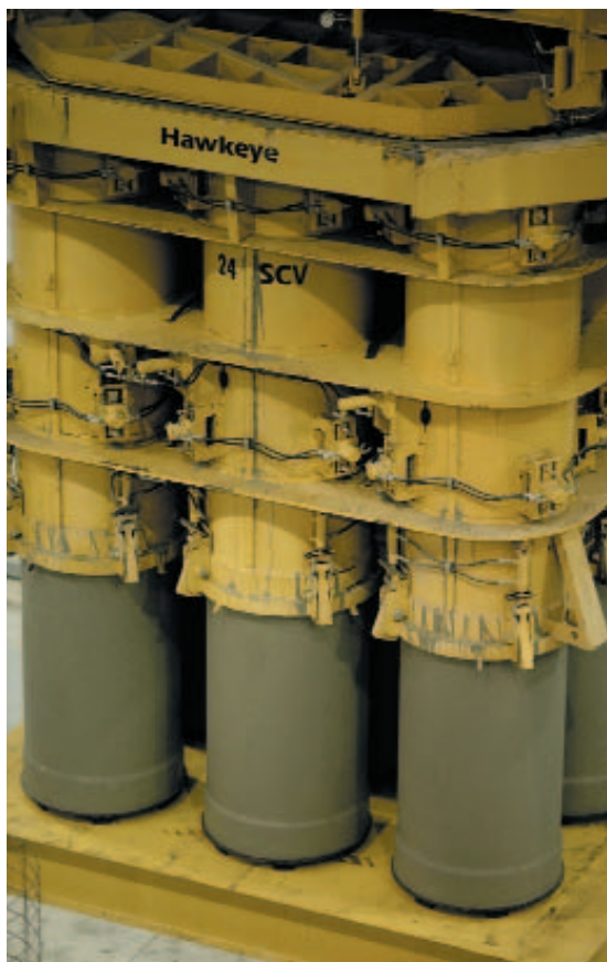
Рис. 5 Набор из форм поднимается, и трубы на поддонах переносятся на транспортную платформу.
