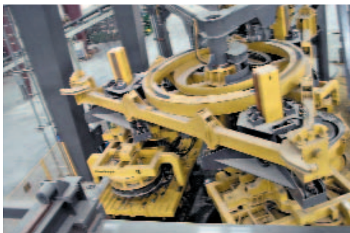
Рис. 2 В состав установки входят три станции: загрузочная, уплотнительная и распалубочная.
