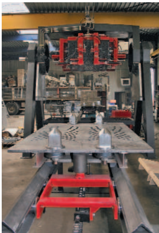
Рис. 5 Опорная плита со штабелем блоков снабжена четырьмя крюками (слева), которые заходят в раму корзины; она, в свою очередь, закрывается при помощи болтов с гидроприводом.
