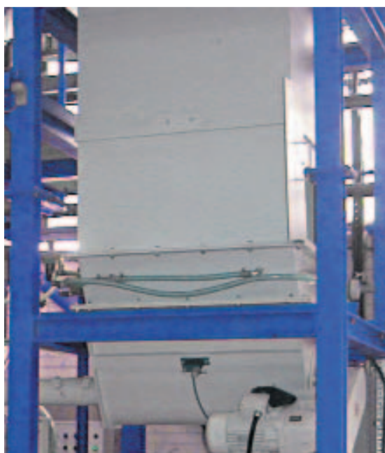
Рис. 5 В качестве опции предлагается расширение бункера.
