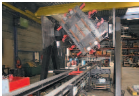
Рис. 4 Корзина целиком вращается вокруг перпендикулярных осей системы.
