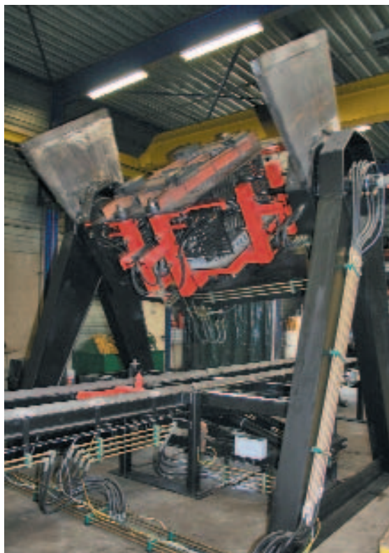
Рис. 4 Корзина целиком вращается вокруг перпендикулярных осей системы.
