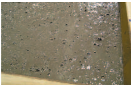
Рис. 23 Выход воздуха во время вибрации.
