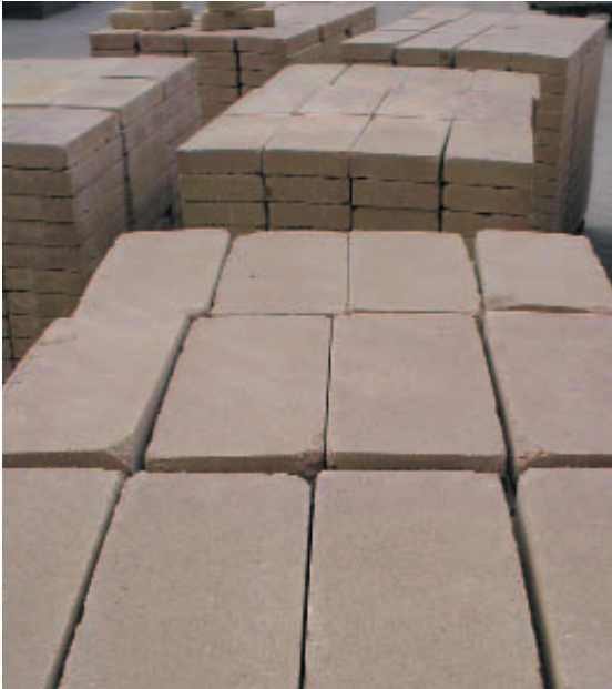
Рис. 8 В настоящее время в Амстердаме с помощью Rota Sage искусственно состаривают в основном крупноразмерные блоки; здесь показаны плитки размером 200 x 400 x 60 мм.
