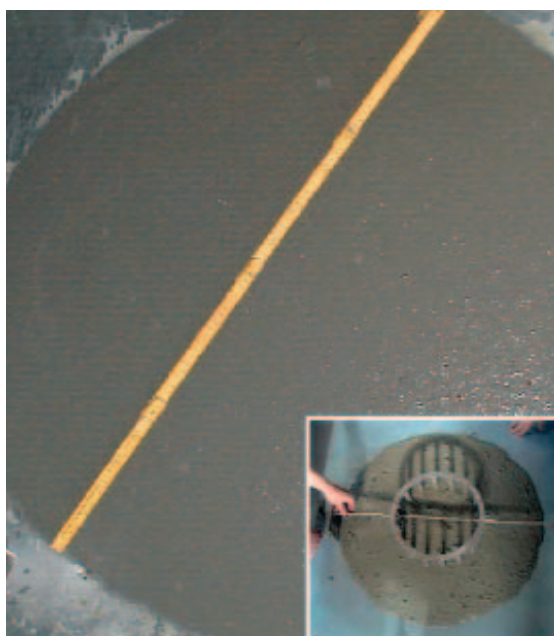
Рис. 4 Определение осадки конуса бетонной смеси для SCC (справа) и УНПС, содержащего стальные волокна (слева).
