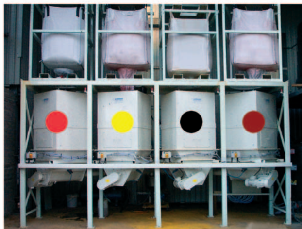
Система дозирования тип TFW 90 для четырех порошковых пигментов
