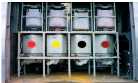
Рис. 1 Система дозирования тип TFW 90 для четырех порошковых пигментов из биг-бэгов.
