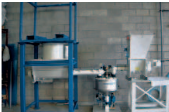
Рис. 6 Пример оборудования для подачи пигментов из биг-бэгов (слева) и из бумажных мешков (справа).
