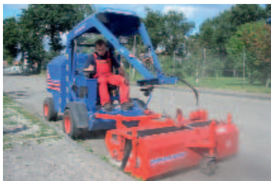
Рис.12 Богатый ассортимент навесного оборудования производства Hydromak включает в себя как разные типы захватов для укладки плитки, так и земляные буры, механизмы для затирки швов строительным раствором, а также подметальные машины с загрузочными бункерами.
