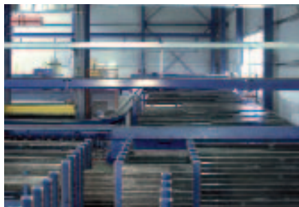
Рис.6 Активный магазин №1 на заводе Каценбергер используется как дополнительное хранилище элементов опалубки и включен в процесс оптимизации.
