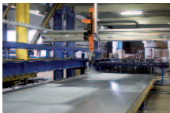
Рис. 2 Робот в процессе смазки поверхности опалубки.
