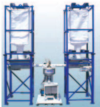
Рис. 4 Система дозирования порошковых пигментов типа TFW 90 с подачей двух пигментов из биг-бэгов.
