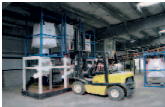
Рис. 5 Система дозирования порошковых пигментов типа TFW – смена биг-бэгов при помощи погрузчика.
