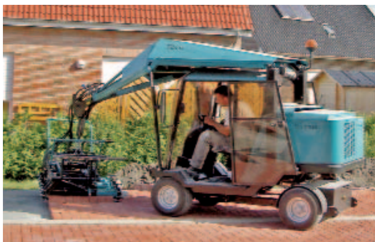
Рис. 1 H88 Toro от Optimas с отличным обзором края рабочей зоны имеет специальную ходовую часть, обеспечивающую малый радиус разворота, также имеется возможность тонкой настройки функций захвата.
