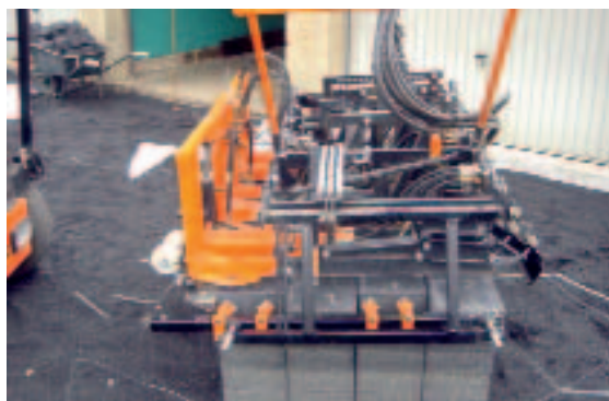
Рис.11 Применение современных захватов, таких как захваты производства Optimas, позволяет переносить и укладывать в ложковую перевязку блоки с разными вариантами стыковки; в данном случае это распространяется даже на прямоугольные блоки.
