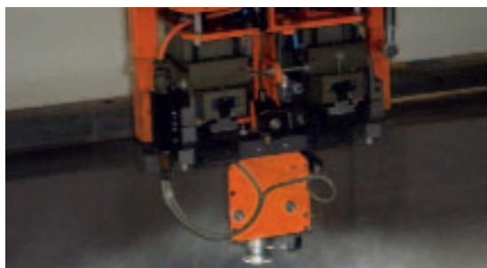
Рис. 4 Грейферный механизм с дополнительным устройством смазки (поворотное сопло).
