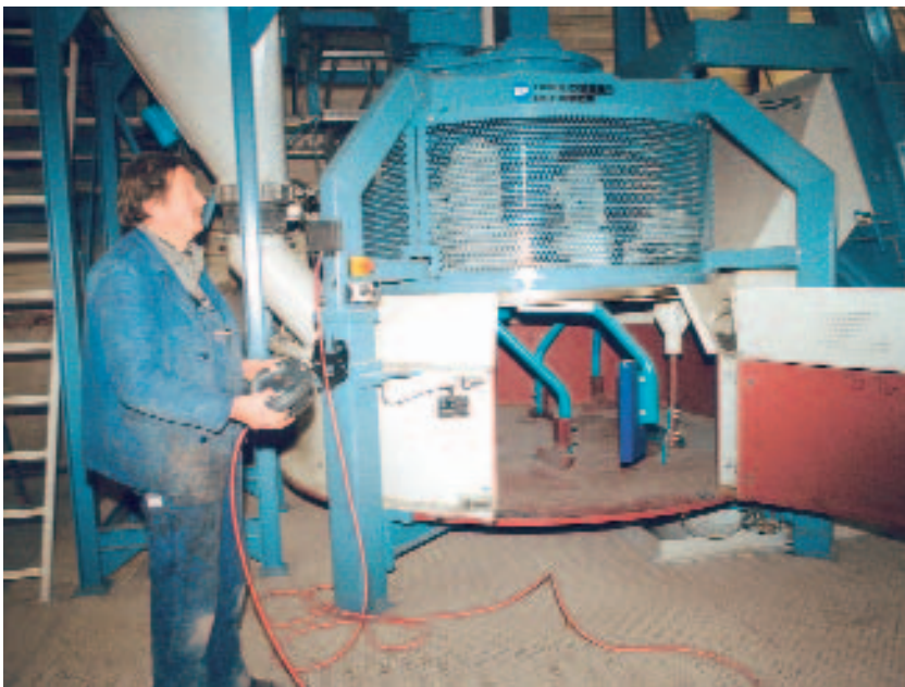
Рис. 6 Пульт дистанционного управления для безопасной эксплуатации установки.
