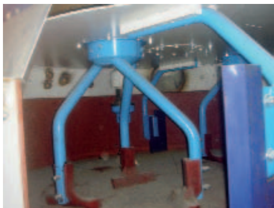
Рис. 3 Вид внутри смесителя.
