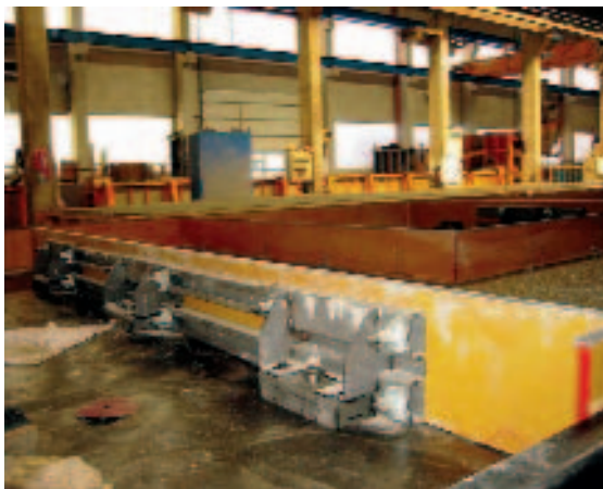
Рис. 5 Формовка трехслойной панели. Толщина 400 мм.
