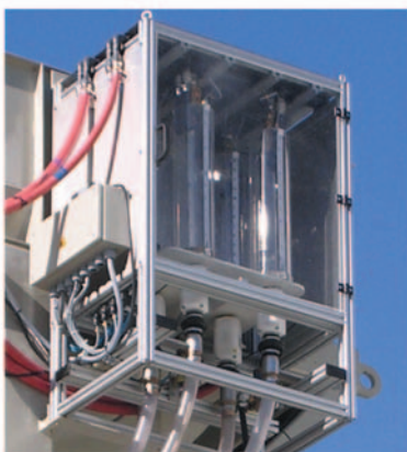
Весы тип AC 15/15/15/15 в защитном шкафу, с четырьмя цилиндрами для восьми различных жидких добавок
