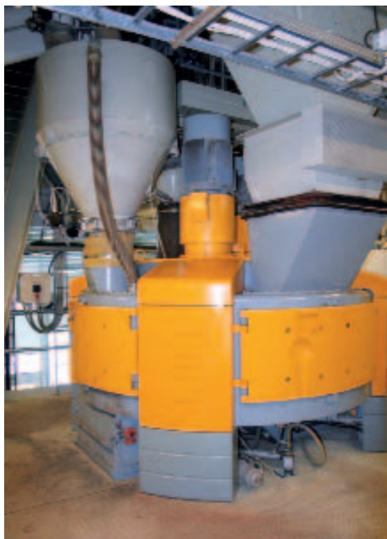
▲ Рис. 2 SKAKO A/S установила три промежуточных бункера меньшего размера с конвейерными лентами под смесителем, благодаря чему стало возможно производство разноцветной продукции.
