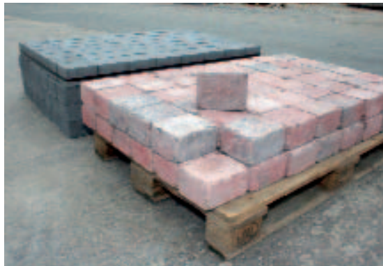
Рис. 9 Бетонные камни, прошедшие обработку в барабане, рядом с необработанной продукцией.
