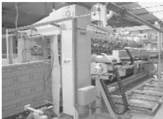
Рис. 3 Поперечный резательный автомат с фрезами для изготовления захватов.
