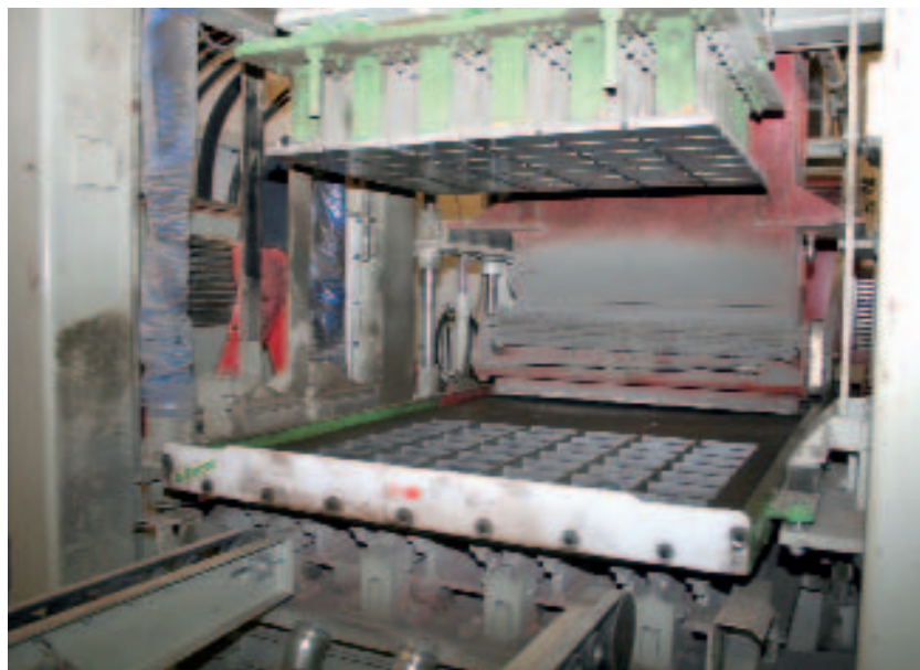
Рис. 3 KVM International A/S поставила установку для изготовления брусчатки вместе с формами; отчетливо видны устройство пылеудаления перед фундаментом установки, выпущенное специально для данного завода, и вибросистема.
