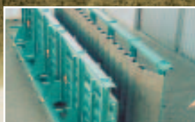
Опалубка для лестничных маршей
