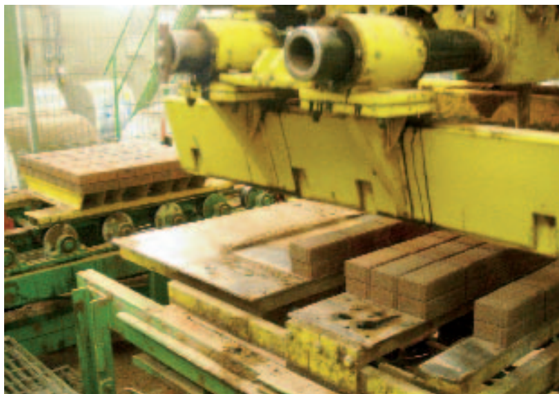
Рис. 3 Формирование пустот для последующей транспортировки на автопогрузчике.
