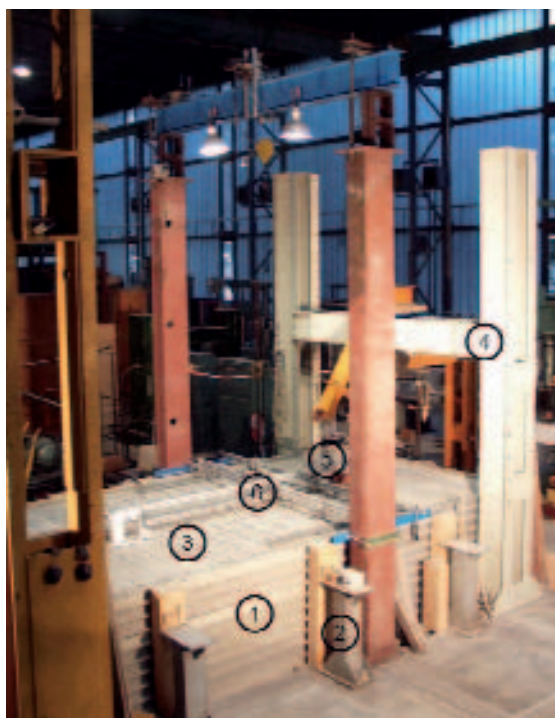
Рис. 2 Испытательный стенд для брусчатки.
