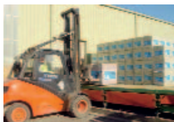
Рис. 7 Транспортировка вилочным погрузчиком: сдвоенный пакет насажен на вилы.
