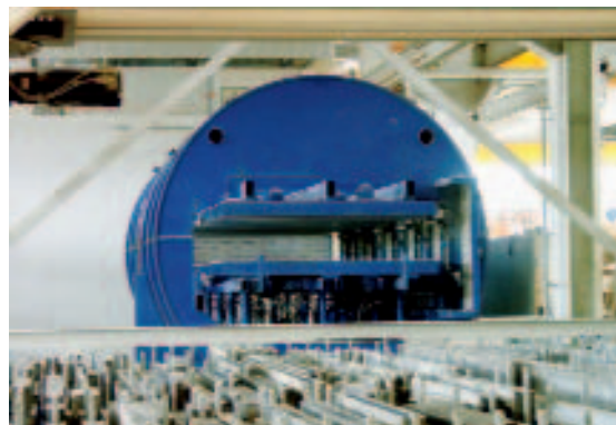
Рис. 2 Сердце установки: здесь поддоны сжимаются вместе с крышкой и вращаются вокруг своей продольной оси под действием высокочастотной вибрации.
