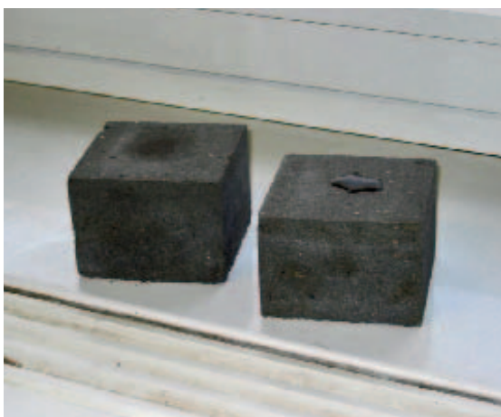
Рис. 1 Обычный бетон (слева), бетон, содержащий 0,6% Sika Paver AE-400.
