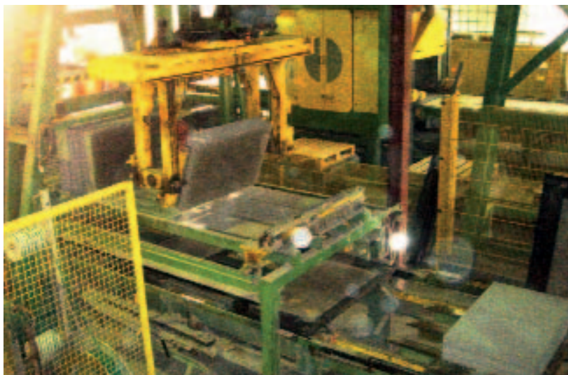
Рис. 1 Крупногабаритные элементы установлены в вертикальное положение.
