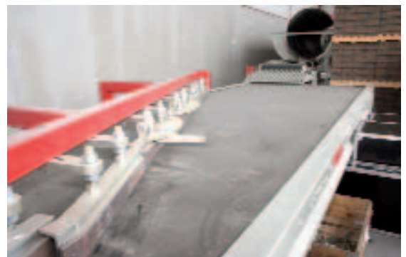
Рис. 11 После обработки в барабане блоки поступают на конвейер ("органайзер"), который доставляет их в заданное место за счет движения ленты и направляющей рамы, закрепленной на конвейере.
