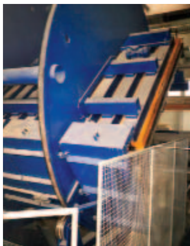
Рис. 5 Во время уплотнения первый поддон и второй противоположный поддон сжаты вместе и вращаются.
