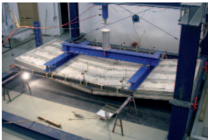
Рис. 9 Повреждения, вызванные изгибом при нагрузке 270 кН.
