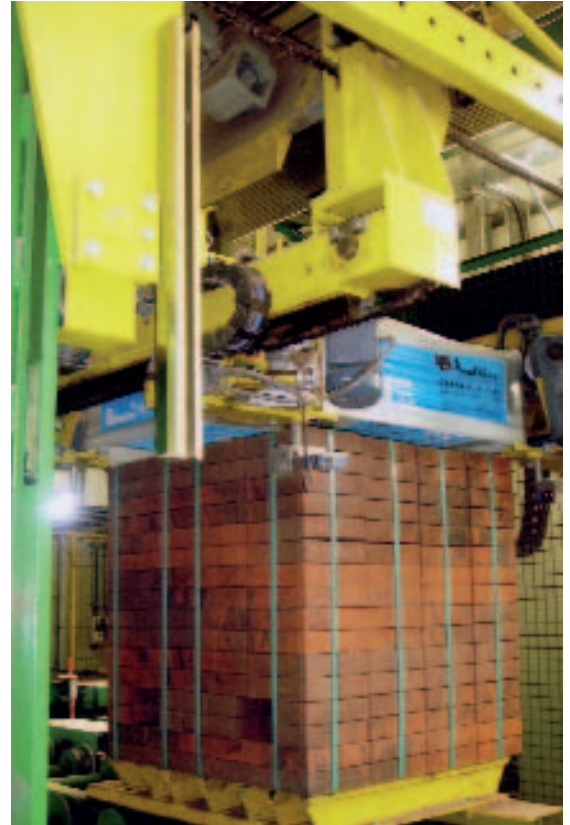
Рис. 5 Упаковка кубов при помощи машины вертикальной упаковки типа "рукав"
