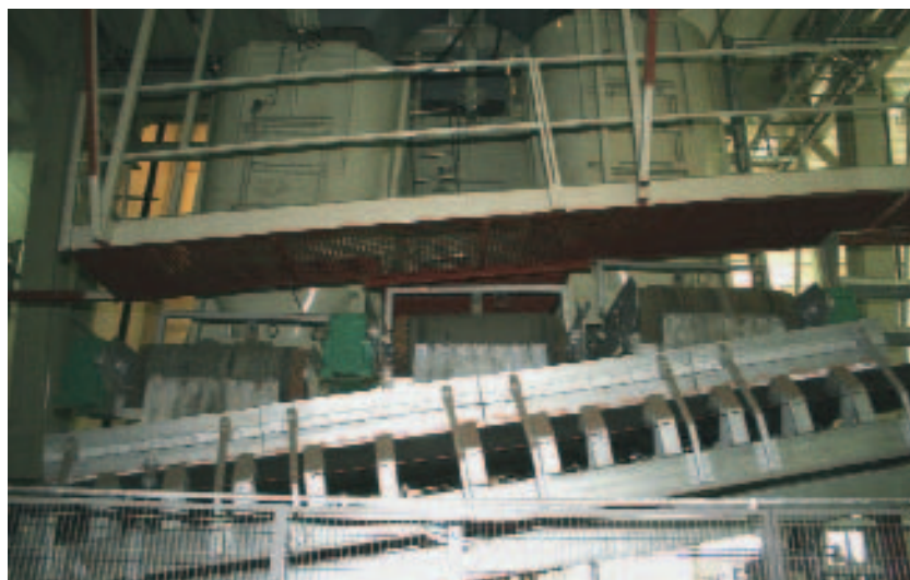
▲ Рис. 2 SKAKO A/S установила три промежуточных бункера меньшего размера с конвейерными лентами под смесителем, благодаря чему стало возможно производство разноцветной продукции.
