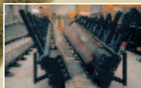
Формооснастка для изготовления балок перекрытий
