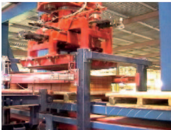
Рис. 12 Слои разнесены для последующего формирования сдвоенных слоев.
