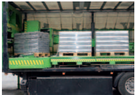
Рис. 8a/b Загруженный поддон заталкивается на поворотный стол, где пакет блоков обертывается эластичной пленкой.
