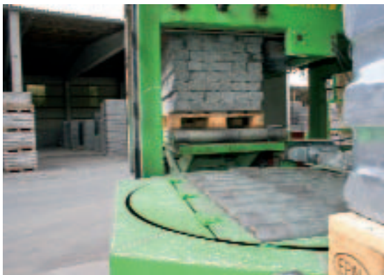
Рис. 8a/b Загруженный поддон заталкивается на поворотный стол, где пакет блоков обертывается эластичной пленкой.
