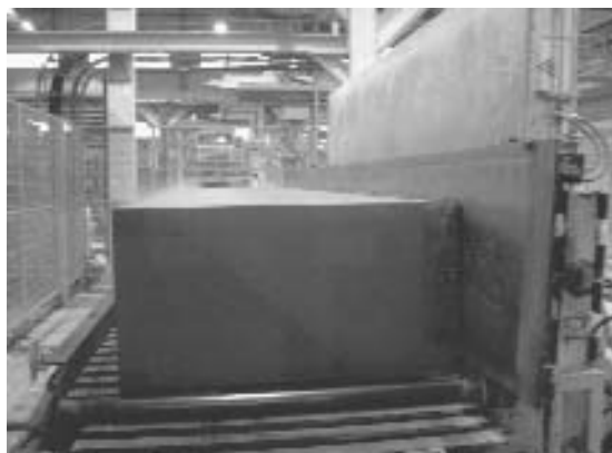
Рис. 4 Двухсоставный кантовочный стол.
