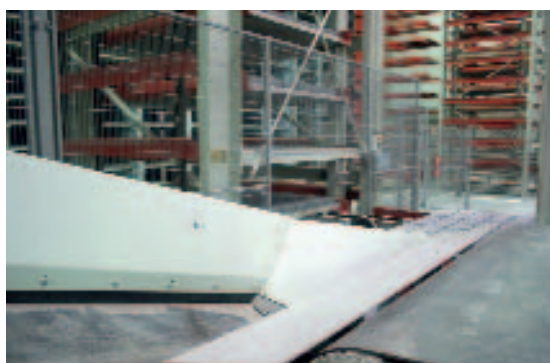
Рис. 8 На коротком ленточном транспортере подлежащие галтовке блоки автоматически доставляются на конвейер, откуда они поступают в галтовочный барабан.
