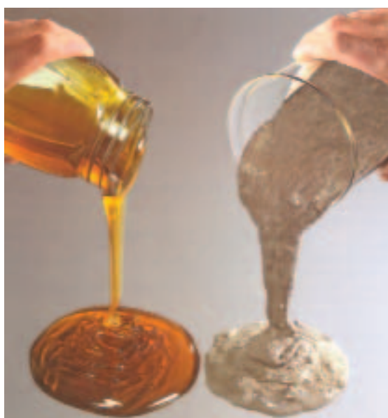
Рис. 1 Самоуплотняющийся бетон, который течет как мед! [1]
