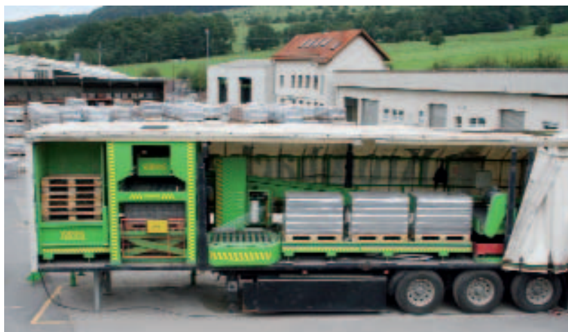
Рис. 2 Технология мобильного пакетирования в автоприцепе на заводе ЖБИ Betonwerk Seiferts.
