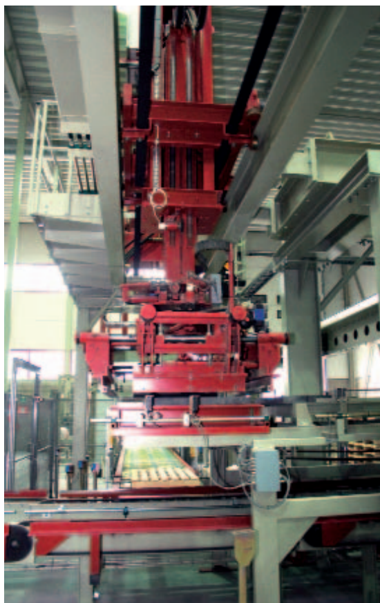
Рис. 6 Третья упаковочная установка формирует штабель слой за слоем, укладывая слои на поддон; но прежде поддон доставляется к месту формирования штабеля роботом-паллетировщиком.
