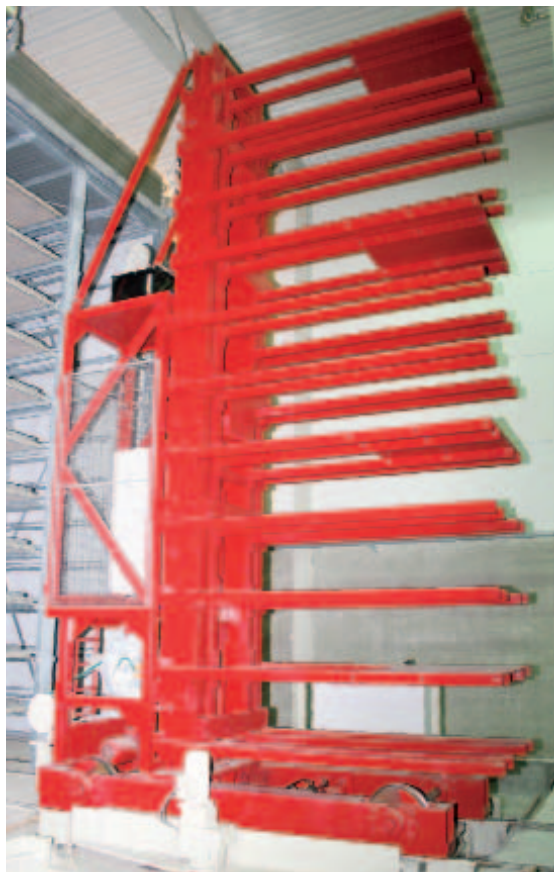
Рис. 4б Полностью автоматизированную вагонетку для блоков с лазерным управлением можно модернизировать под использование всех щитов при помощи приспособления double-fox.
