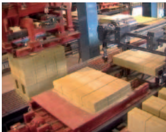
Рис. 14 Подготовленные слои блоков.
