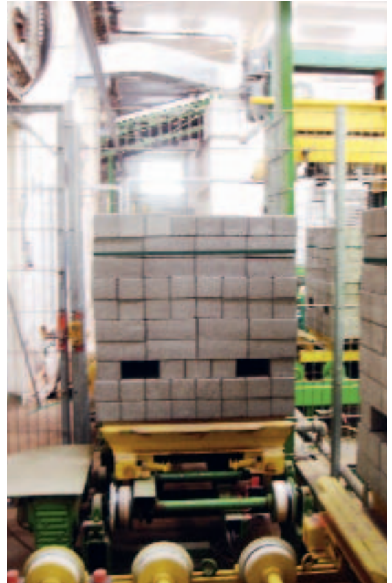
Рис. 10 Набранный куб с пустотами в отдельных слоях.
