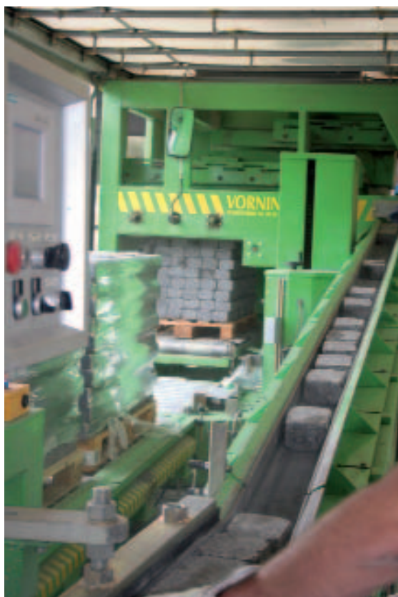
Рис. 5 Поступающие блоки заталкиваются на подложку в пределах размеров поддона.
