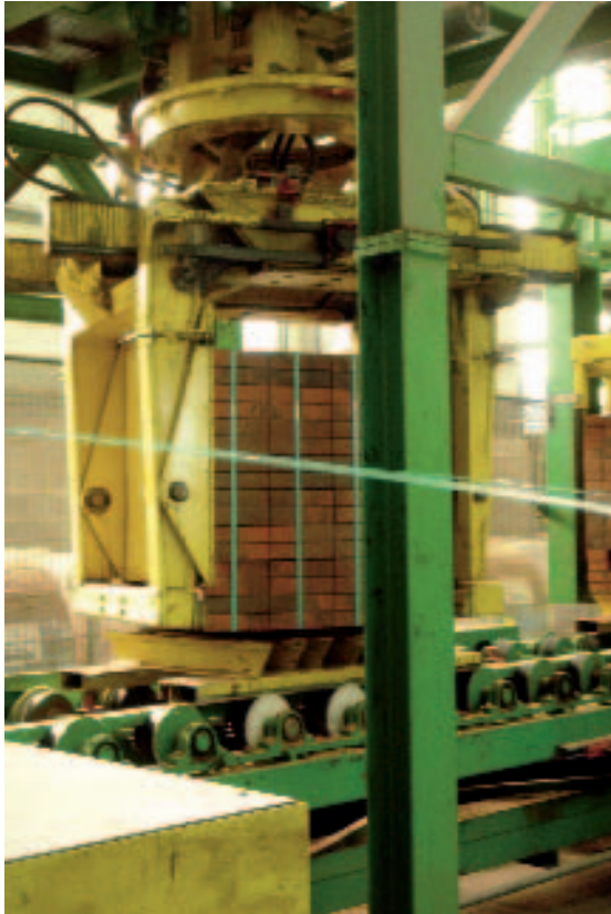
Рис. 4 Куб повернут для повторной вертикальной обвязки.
