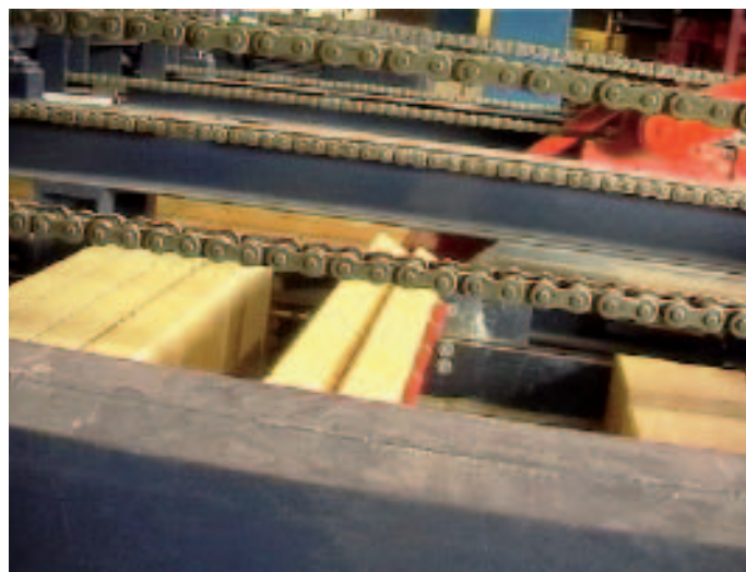
Рис. 13 Участок установки блоков в вертикальное положение - часть комплексной схемы изменения формата, применяемой в австралийской компании BGC PTY.
