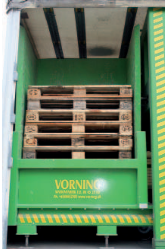
Рис. 7 Магазин может вмещать до 10 поддонов, которые загружаются в него автопогрузчиком.
