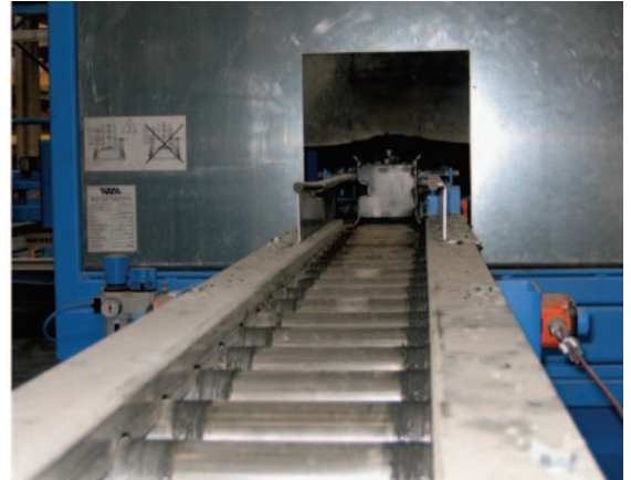
Рис. 7 Укладка элемента опалубочной формы на транспортере, прохождение через устройство очистки и смазки, нанесение окончательной маркировки и его снятие роботом для опалубки.
