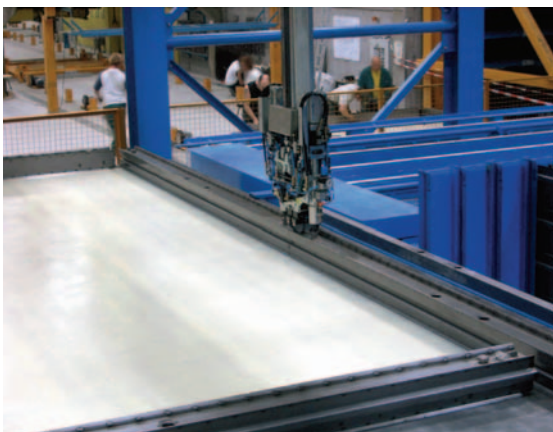
Рис. 4 Все работы по установке опалубки на поддоне с помощью робота для изготовления опалубки.
