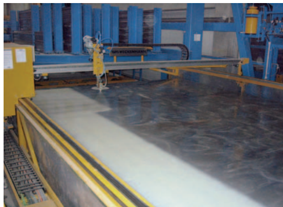
Рис. 3 Автоматическая очистка и смазка поддонов (слева), частичное нанесение замедляющего лака для декоративной обработки видимой поверхности бетона с помощью робота для окрашивания (справа).
