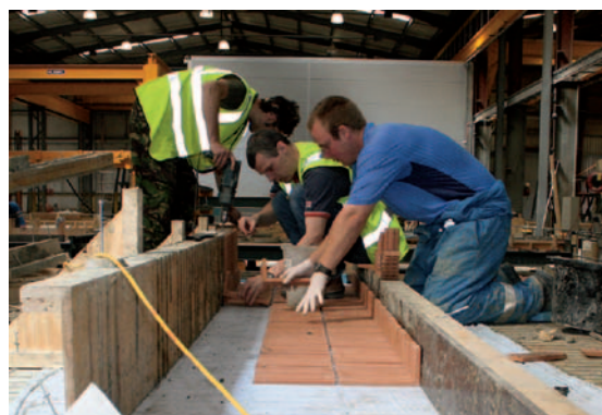
Рис. 3 Укладка клинкерных кирпичей в форму требует аккуратности.
