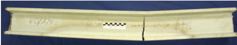
Рис.5 Образец после испытания (образец 7-03, AR-стеклоткань).
