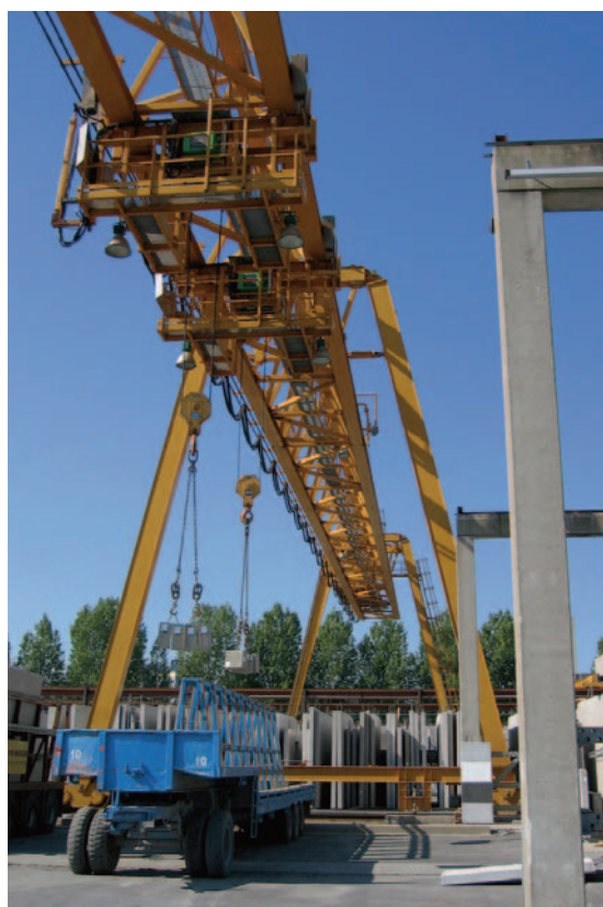
Рис. 9 Готовое промытое сборное железобетонное изделие помещается в ячейку накопителя, относящуюся к конкретному заказу, либо загружается непосредственно на автомобильный прицеп.
