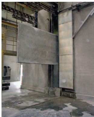
Рис. 8 Промывка декоративного бетонного слоя в специальной установке.
