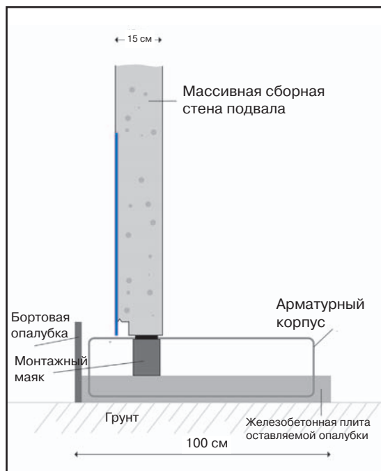
Рис. 2 Эскиз фундаментной плиты PENTAFLEX Integral.
