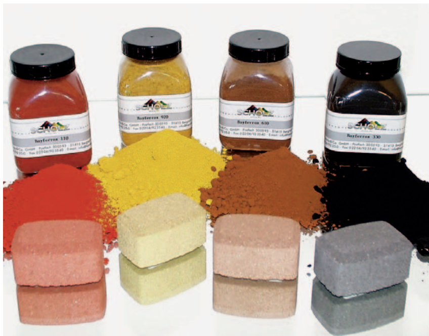
Рис. 1 Образцы, окрашенные железоксидными пигментами (слева направо): Bayerferrox® 110, Bayerferrox® 920, Bayerferrox® 610, Bayerferrox® 330.
