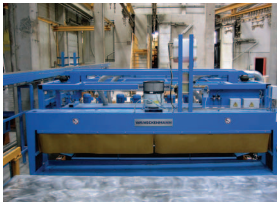
Рис. 3 Автоматическая очистка и смазка поддонов (слева), частичное нанесение замедляющего лака для декоративной обработки видимой поверхности бетона с помощью робота для окрашивания (справа).
