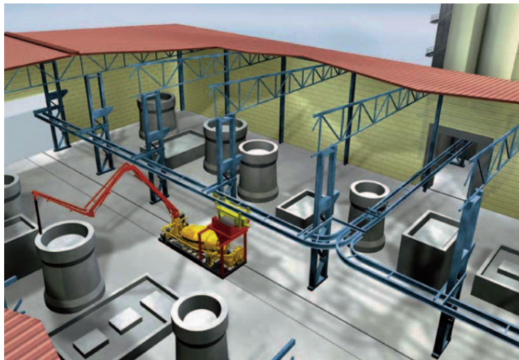
Рис. 2 Схематическое изображение использования установки AUTOCOR на заводах ЖБИ. Гибкая бетонораспределительная стрела позволяет заливать бетон в опалубки любых типов.
