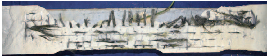
Рис.10 Образец 5-03-2 после испытания (вид снизу).
