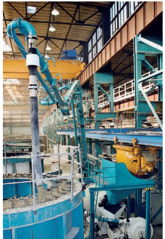
Рис. 1 Перекрывающий клапан на конце шланга предотвращает разбрызгивание бетона при перемещении стрелы. Система управления EBS осуществляет амортизацию при нежелательных вибрациях стрелы.
