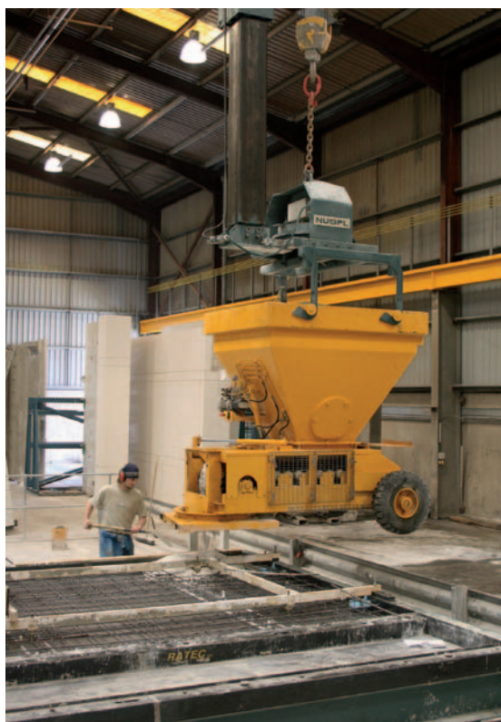
Рис. 6 Бетоноукладчик на заводе компании Techrete.
