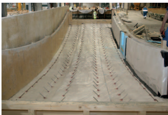
Рис. 2 Формы для кольцевых элементов. Для облицовки используется тонкая плитка из природного камня.
