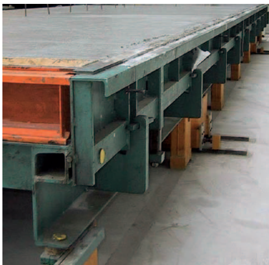
Рис. 9 Регулируемые по высоте борта циркулирующей формы.
