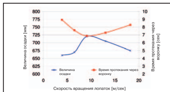
Рис. 6 Изменение свойств свежего бетона в зависимости от скорости вращения лопаток активатора.
