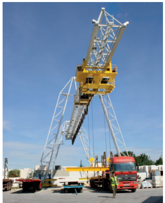
Рис. 8 Для штабелирования на открытых участках Techrete приобрела высокопроизводительный порталный кран.
