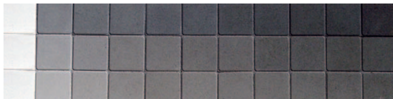
Рис. 3 Палитра железоксидных пигментов. Снизу вверх: оксид железа 1, оксид железа 2, BFX 360, от 1% до 10% (интервал в 1%). Слева везде "нулевой" блок без окраски. Блоки изготовлены из белого цемента.
