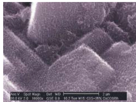
► FIG. 2 Calcium silicate hydrate outgrowth from limestone particles. // ABB. 2 Calciumsilikathydrate auf Kalksteinpartikel aufgewachsen.
