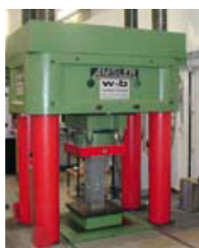
▲ FIG. 1 Experimental set-up and fracture pattern of the test specimens made of UHPRFC and high-strength longitudinal reinforcement. // ABB. 2 Versuchsstand und Bruchbilder der Versuchskörper aus UHPRFC und hochfester Längsbewehrung.
