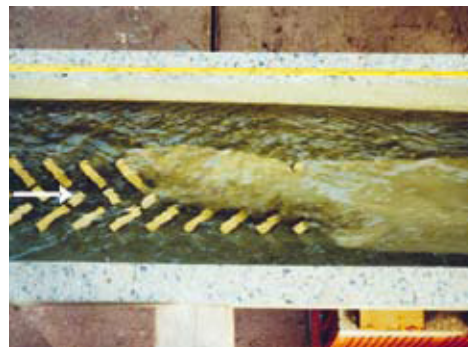
▲ FIG. 2 Removal of sediments (arrow indicates direction of flow) [4]. // ABB. 2 Abtrag von Sediment (Pfeil: Strömungsrichtung) [4].
