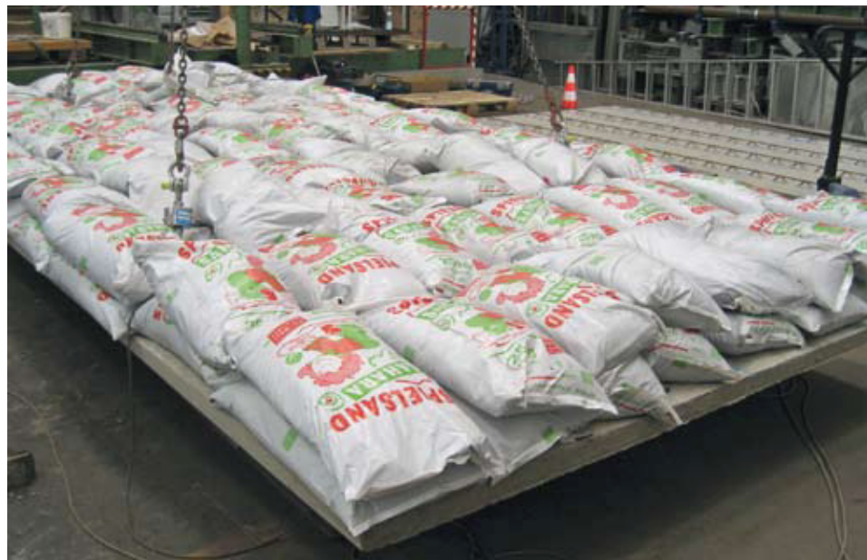
► FIG. 1 Experimental setup and uniform loading of a floor plate with sand bags // ABB. 2 Versuchsaufbau und gleichmäßige Belastung einer Elementdeckenplatte mit Sandsäcken.
