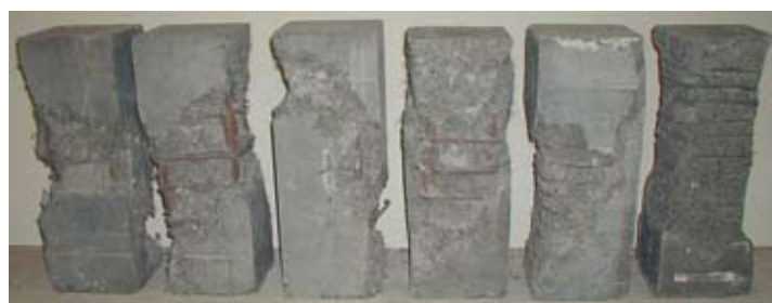
▲ FIG. 1 Experimental set-up and fracture pattern of the test specimens made of UHPRFC and high-strength longitudinal reinforcement. // ABB. 2 Versuchsstand und Bruchbilder der Versuchskörper aus UHPRFC und hochfester Längsbewehrung.
