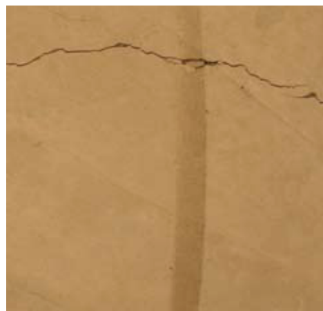
◀ FIG. 3 Fracturing of crack edges after a test run (Kaiserslautern University of Technology). // ABB. 3 Rissflankenbrüche nach einem Versuchslauf (TU Kaiserslautern).
